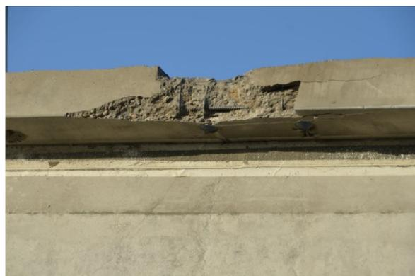
**Abbildung 4.10:** Versuchsträger V1: Abplatzung an der Lasteinleitungsstelle
