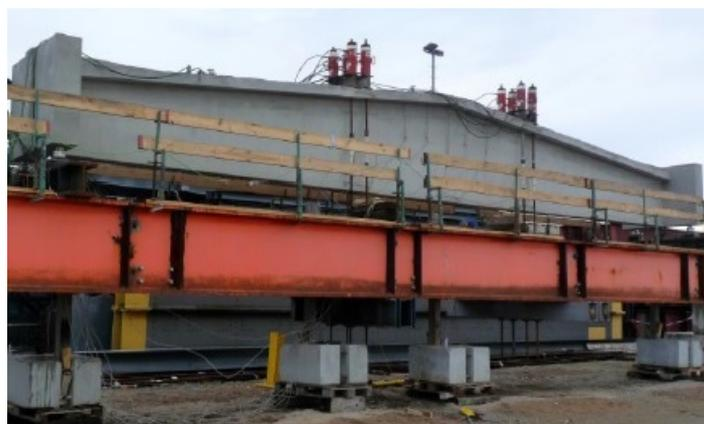
**Abbildung 5.3:** Versuchsaufbau des Versuchsträgers V3
