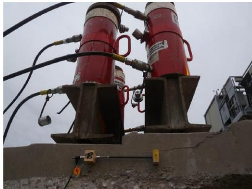
**Abbildung 4.13:** Versuchsträger V2: Deutliche Rissbildung an der Lasteinleitungsstelle
