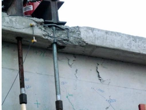
**Abbildung 5.11:** Versuchsträger V4: Abplatzung an der Lasteinleitungsstelle +2,0 m
