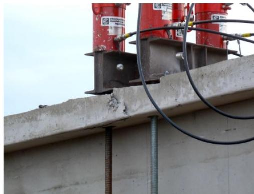
**Abbildung 5.8:** Versuchsträger V3: Abplatzung an der Lasteinleitungsstelle +2,0 m
