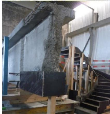
**Abbildung 4.2:** Schalung der Endverankerung für den selbstverdichtenden Beton nach dem Durchtrennen des Trägers
