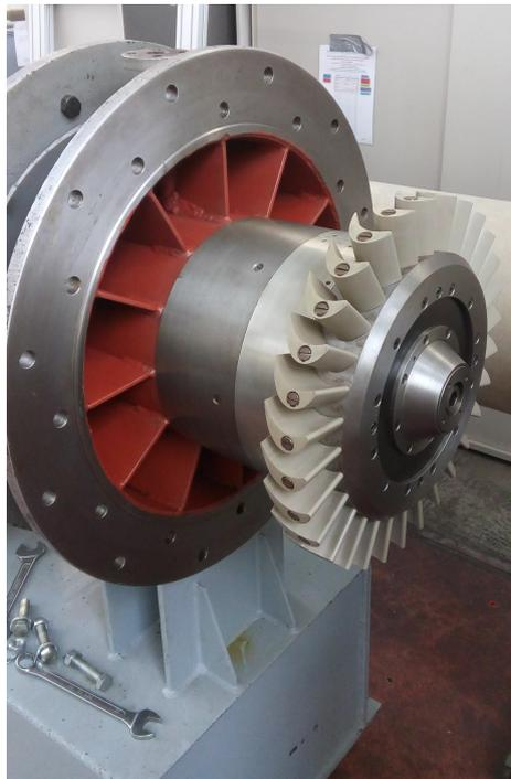
Abbildung 7.3: Luftturbine nach der Demontage des Gehäuses
