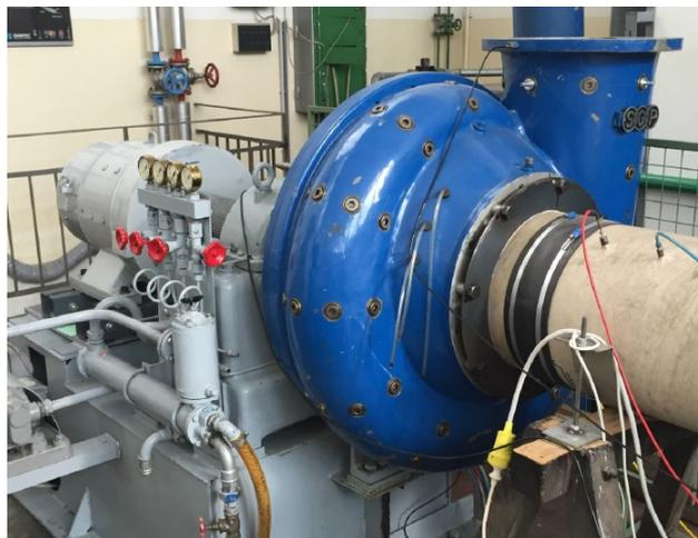
Abbildung 4.4: SGP-Luftversorgungsprüfstand [24]
