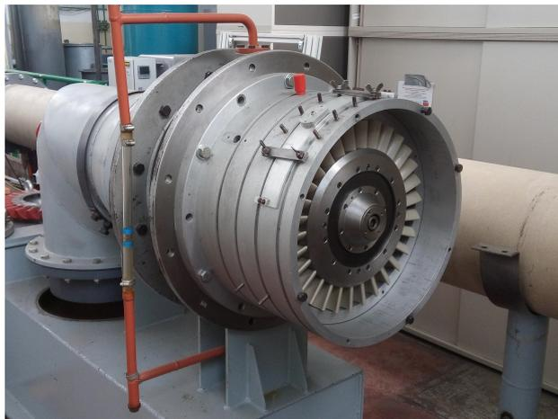
Abbildung 7.2: Luftturbine nach Demontage der ersten Leitschaufelreihe
