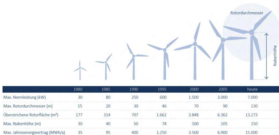
Abbildung 12 - Technologische Weiterentwicklung von Windkraftanlagen seit 1990 [10]
