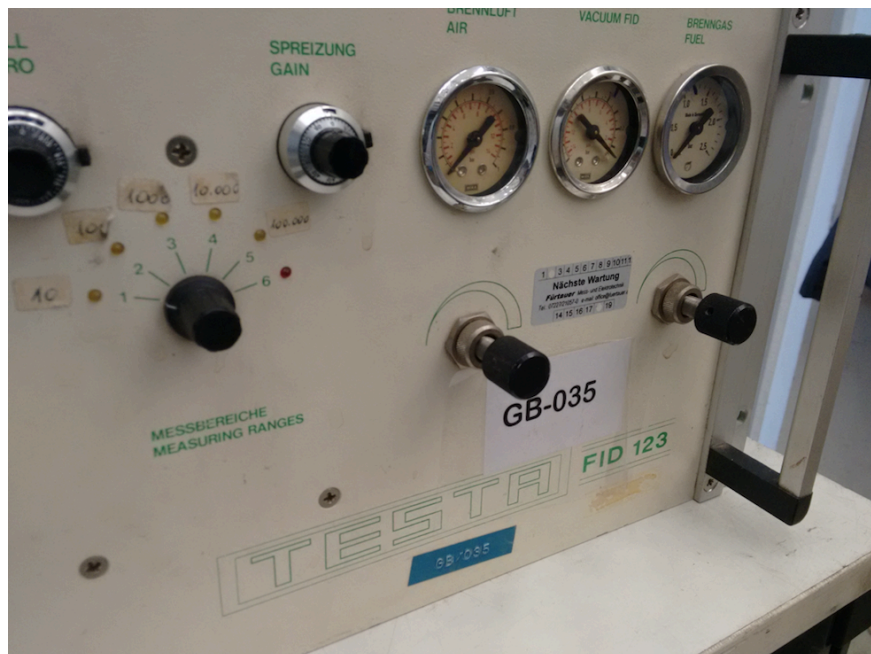
Abbildung 39 - Verwendeter FID im Pilotversuch
