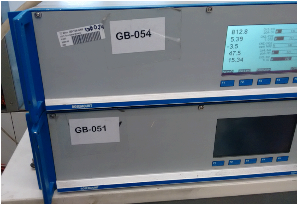
Abbildung 40 - Verwendetes Messgerät zur Bestimmung von Sauerstoff, Kohlenmonoxid, Kohlenstoffdioxid
