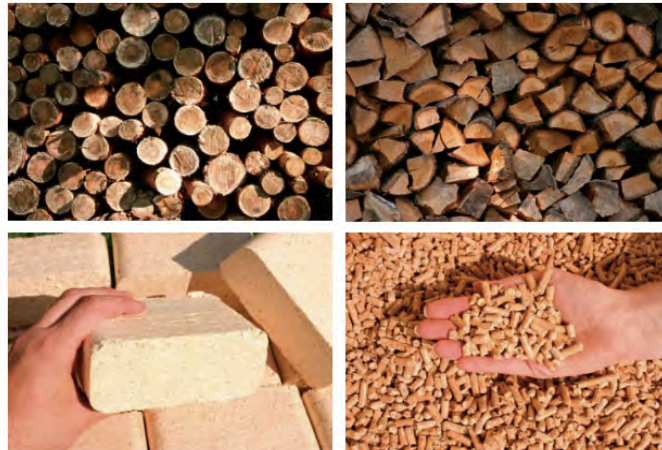
Abbildung 8 - Von Links oben nach rechts unten: Rundholz, Scheitholz, Holzbriketts, Holzpellets [4]
