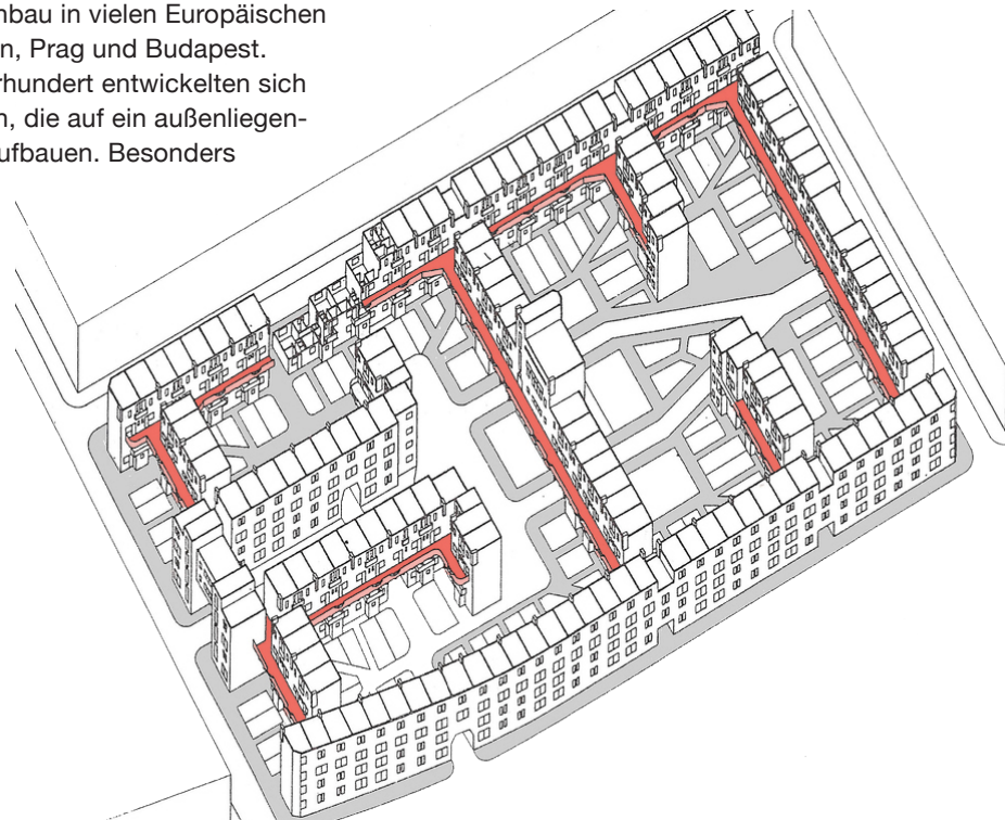
Abb. 28: In der Axonometrie des Justus van Effen Complex ist die erhöhte Straße farblich markiert: Justus van Effen Complex , Michiel Brinkman, 1922, Rotterdam – NL.
