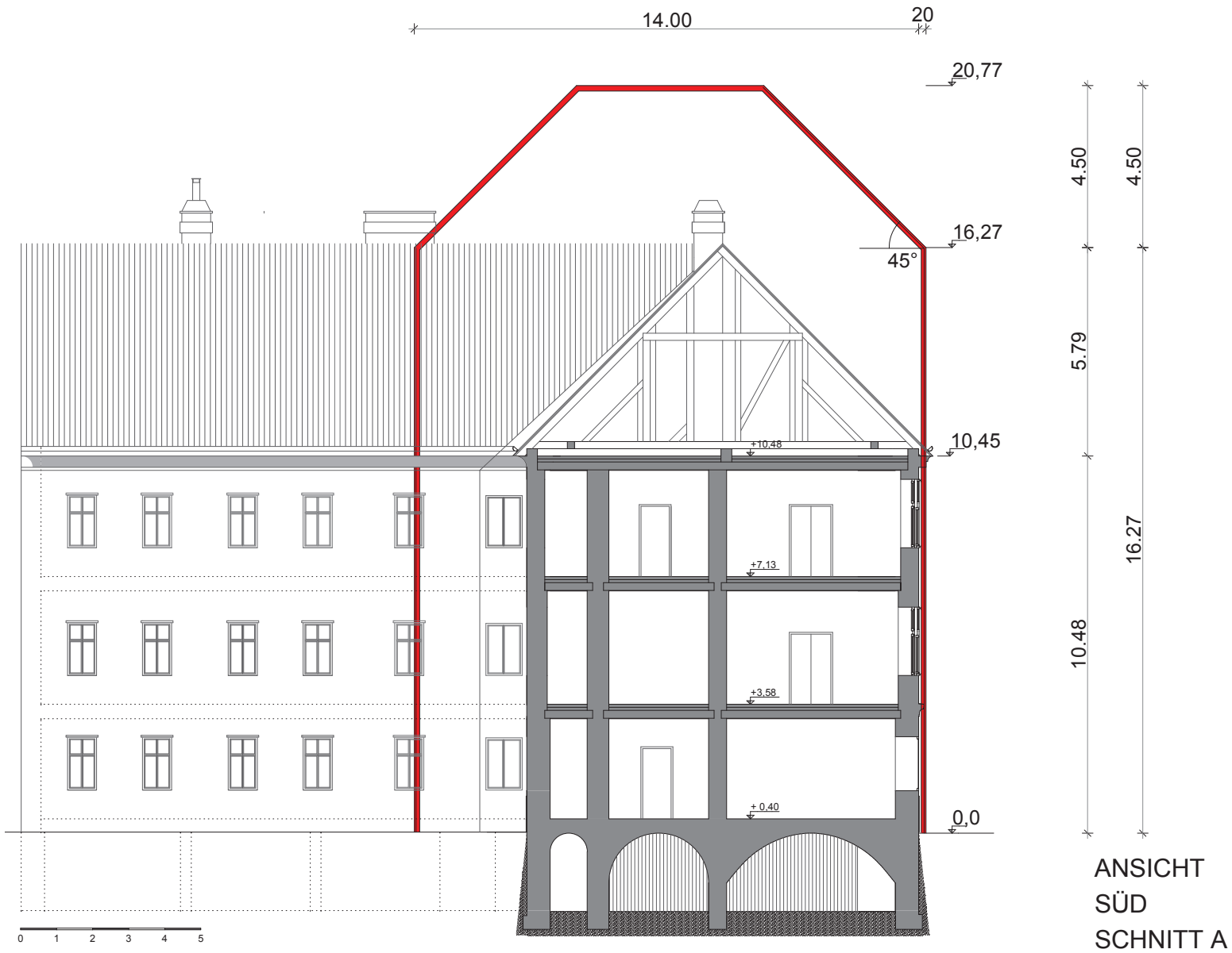
Abb. 40: Baurechtlich mögliche Tiefe und Höhe
