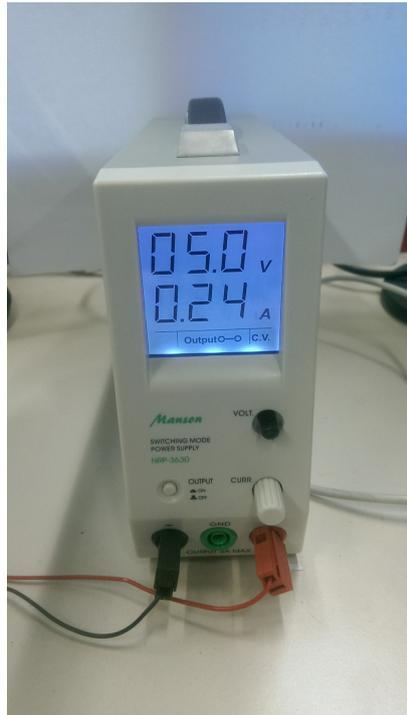
Abbildung 7: Manson NRP-3630 Power Supply zur externen Energieversorgung von SC-2345
