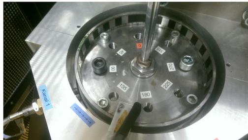
Abbildung 22: Rotor mit Wuchtgewichten-Schrauben
