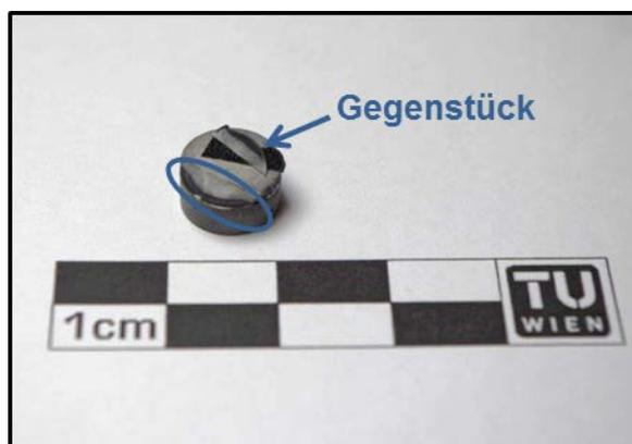
Abbildung 74: lasergeschnittene WC/Diamant-Co Probe aus der Diplomarbeit von Bettina Ritt
