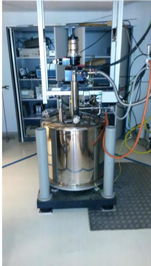
Abbildung 2.3: Vibrating Sample Magnetometer
