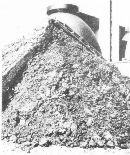
Abb. 8: Mit Branntkalk verfestigter, zentrifugierter Faulschlamm auf der Kläranlage Ravensburg
