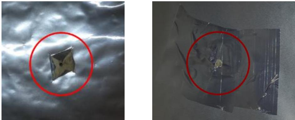
Abb. 43: Links: Versuch 5 ohne Beklebung der Dampfbremse
