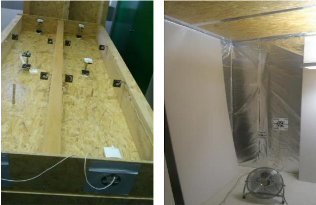
Abb. 22: Links: 2 Gefach mit eingebauten CO<sub>2</sub> Sensoren und Lüfter
