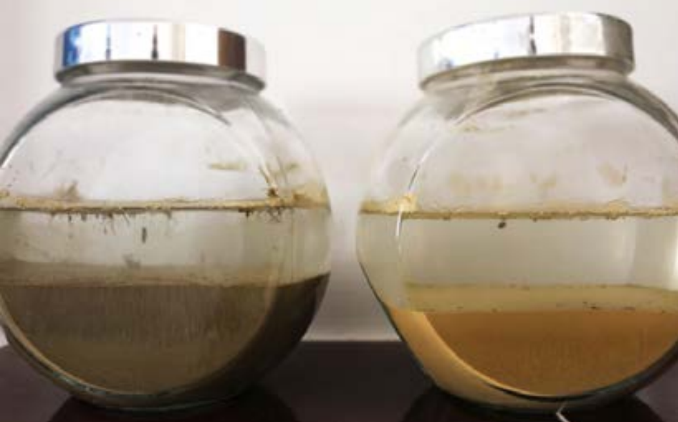
Abb. 01.15: Sedimentationstest mit Lehm aus Sopron (links) und Herzogenburg (rechts) Abb. 01.16: Grafik der Funktionsweise des Sedimentationstest
