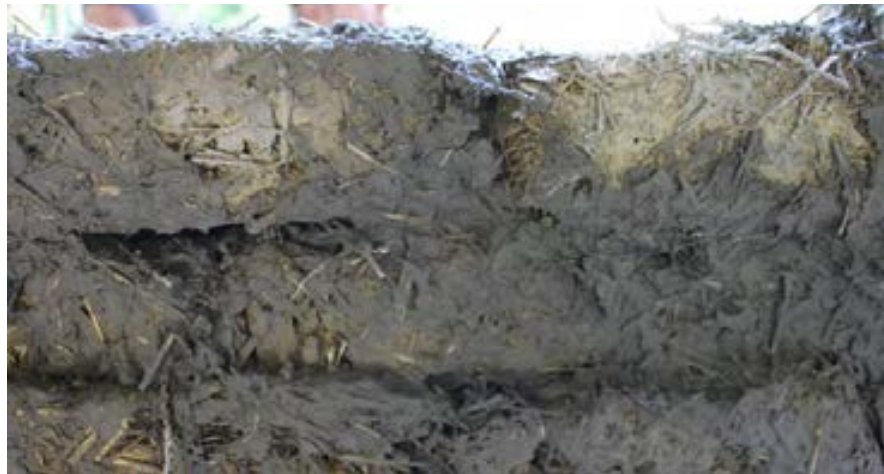
Abb. 03.36: Leichtlehmziegel beim Trocknungsprozess
