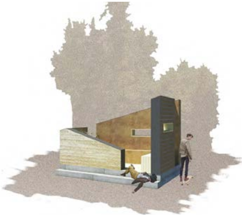
Abb. 04.3: Entwicklung des Baukörpers Abb. 04.4: Visualisierung des Baukörpers mit einer Stampflehm-, Weller- und Lehmziegel- wand
