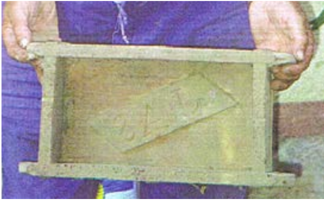
Abb. 03.19: bis ins 20 Jhdt. verwendetes Ziegelmodell aus Stettenhof Abb. 03.20: Ziegelmodell aus Holz für drei Ziegel aus dem Workshop in Sopron
