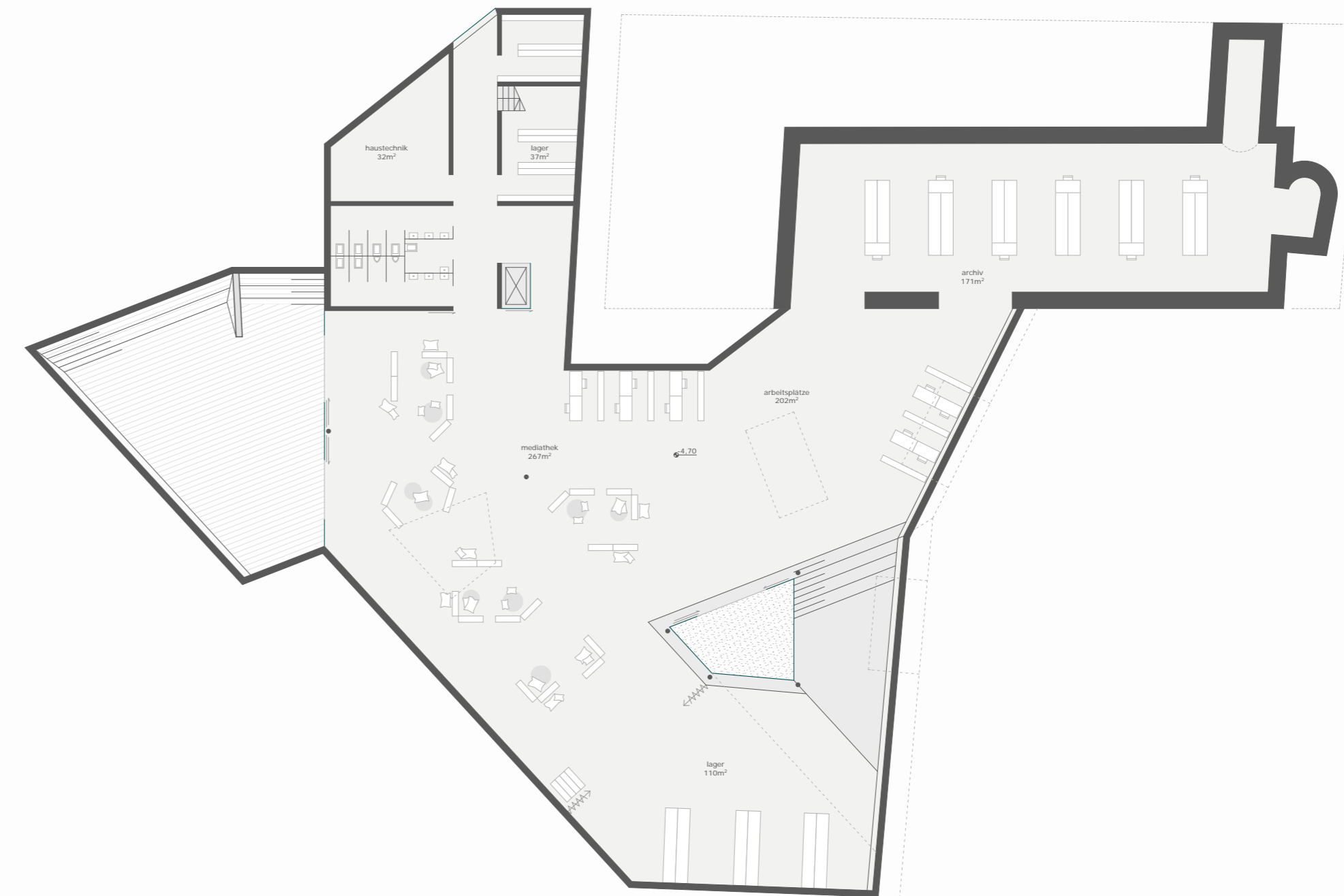
Grundriss Untergeschoß, M 1:250 Archiv, Mediathek, Lager, Haustechnik
