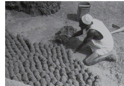
Abb. 25 Zum Trocknen aufgestellte Tubali
