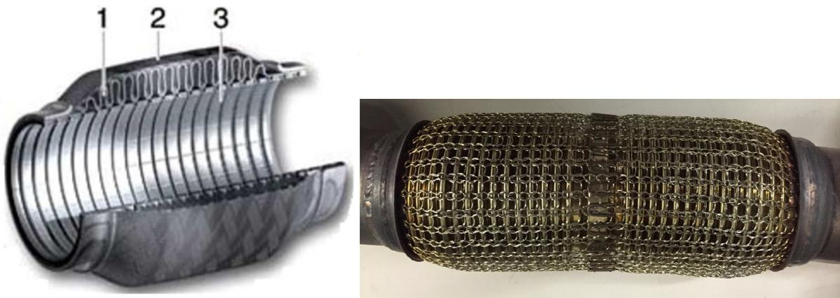
**Abbildung 6-6:** Aufbau eines Entkoppellementes im Abgasstrang [41] (links) und ein Bild des Entkoppellementes der Anlage (rechts)
