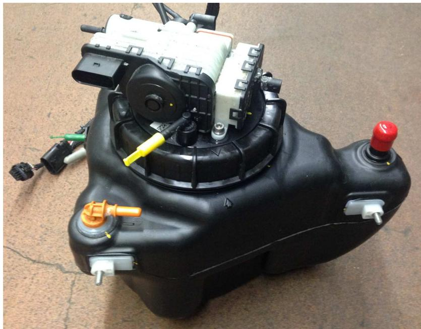
**Abbildung 5-3:** AdBlue-Tank inklusive integrierte Förderpumpe
