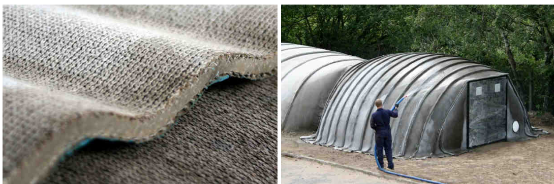
Abbildung 8 Fasermatrixgewebe von Concrete Canvas (links), aufgeblasene Behelfsüberdachung von Concrete Canvas (rechts) [67], [68].
