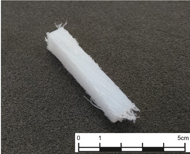
Abbildung 16: GUR 1020-Block vor dem Pressvorgang
