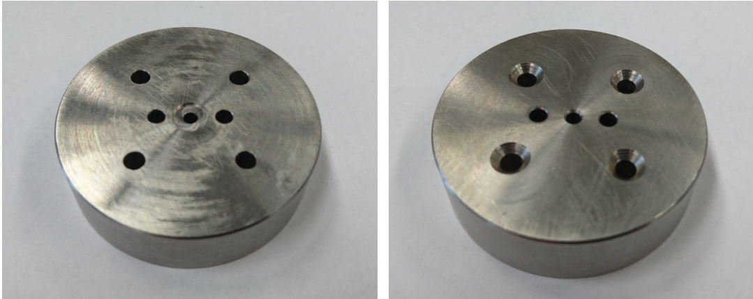
Abbildung 25: Führung, links: Aufnahme der Probe-Innenseite; rechts: Verschraubungsseite-Außenseite Abbildung 26 zeigt die gefertigte Matrize mit bereits eingepressten Passstiften.
