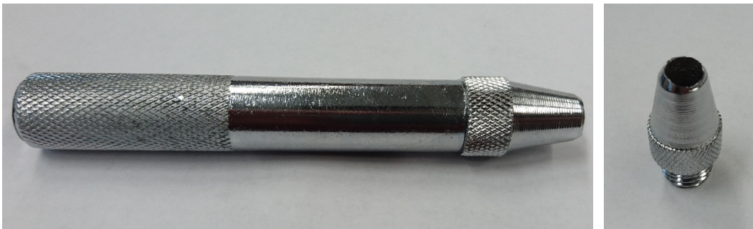
Abbildung 18: Stanzwerkzeug für UHMWPE-Proben
