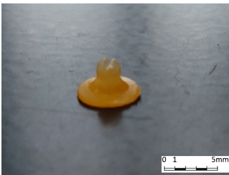
Abbildung 34: Small Punch mit PE 100, Probe Nr.1
