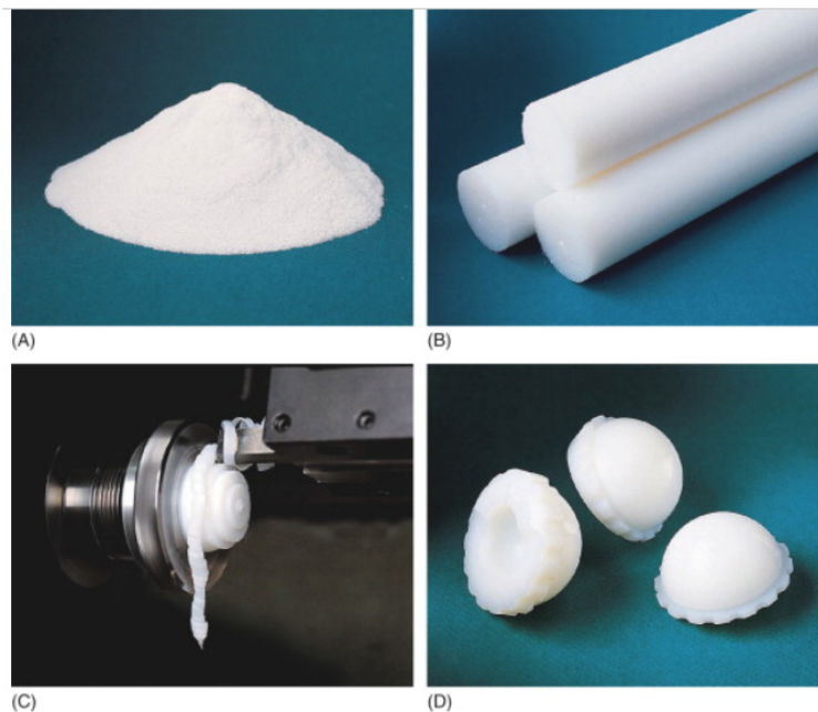
Abbildung 12: typischer Fertigungsschritte bei der Erstellung von Endoprothesen aus UHMWPE (1)
