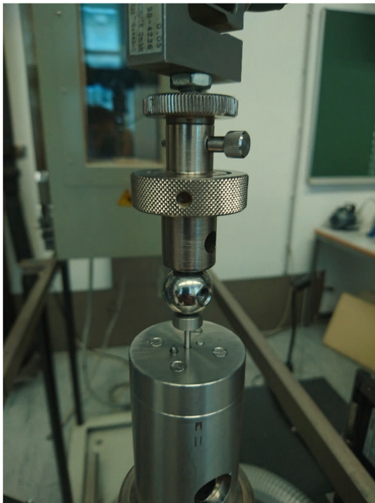
Abbildung 31: Nahaufnahme der Kugel zwischen Vorrichtung und Prüfmaschine
