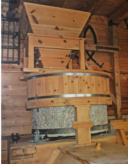
Abb. 10: Trichter über dem Mehlkasten
