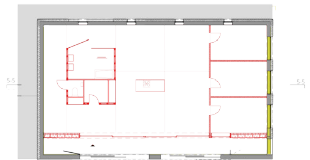
3.54 | Phase 3_Abbruch Untergeschoß
