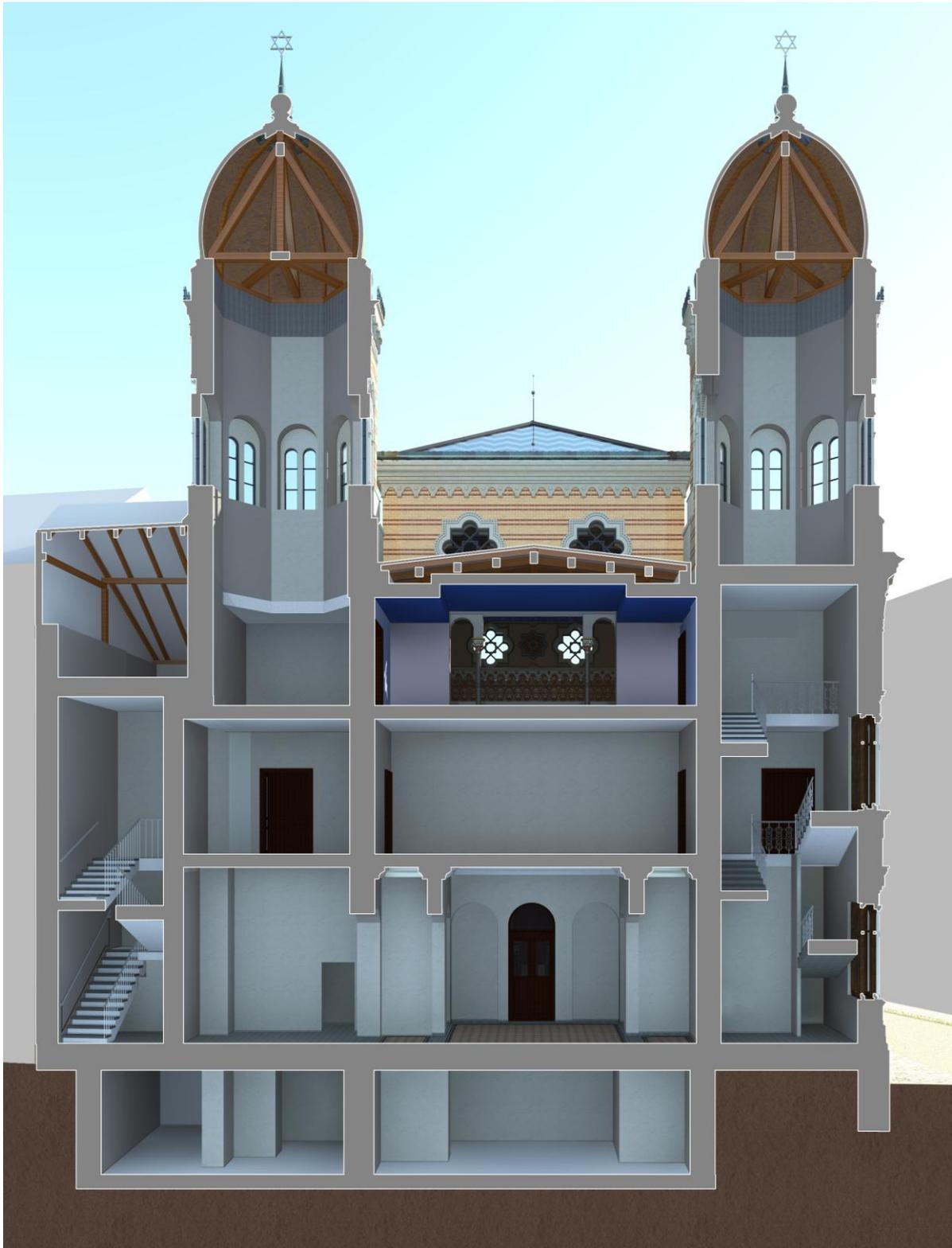
Abb. 157 Querschnitt durch die Türme
