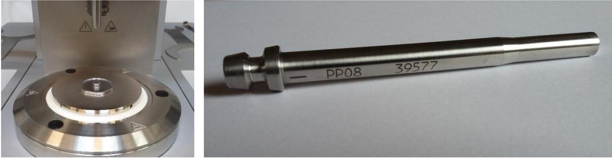
**Abbildung 3-4: Platte-Platte System, Prüfgeometrie PP08**
