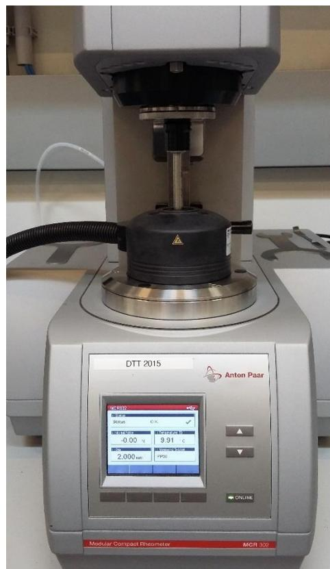
Abbildung 3-1: Dynamisches Scherrheometer – Anton Paar MCR 302
