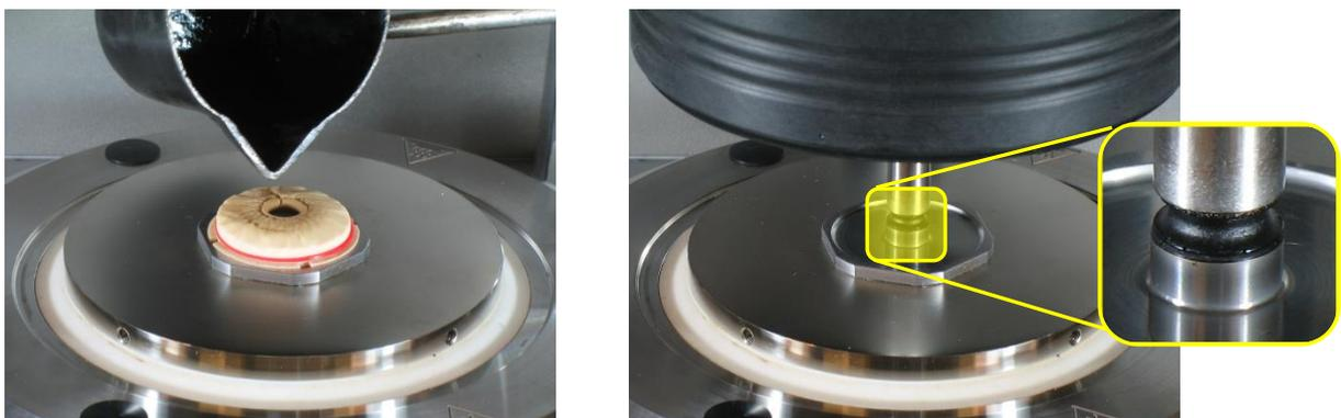
Abbildung 3-8: Eingießen der Mastix, fertiger Probekörper [2]
