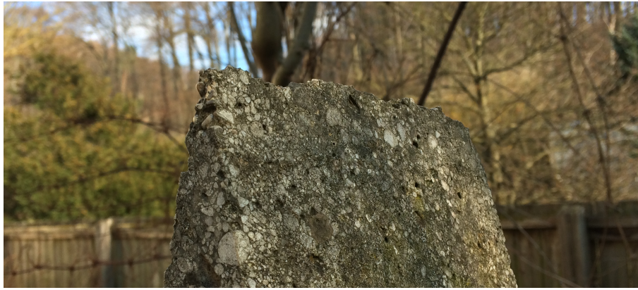
Abb. 29 Reliefbildung an der Spitze des Lindabrunner Konglomerat
