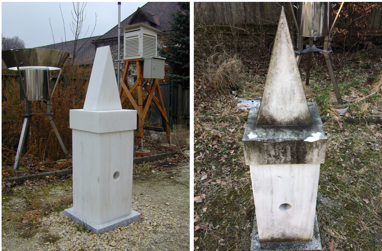
Abb. 7 Laaser Marmor (links: zu Expositionsbeginn 2003; rechts: nach knapp 14 Jahren freier Exposition)
