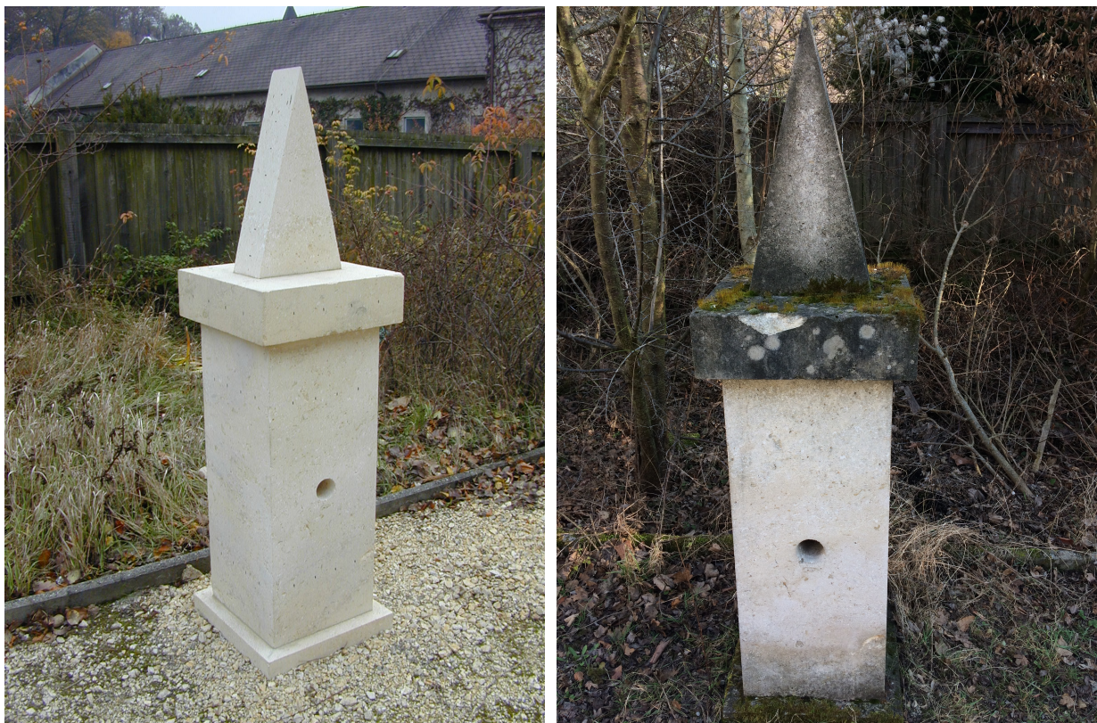
Abb. 5 Aflenzer Kalksandstein (links: zu Expositionsbeginn 2003; rechts: nach knapp 14 Jahren freier Exposition)
