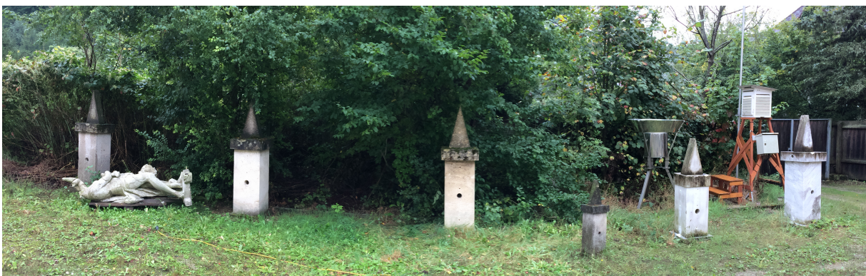
Abb. 1 Fünf historisch bedeutsame Bau- und Dekorgesteine zur Freiluftlangzeitverwitterung in exponierter Lage in einem Hof der Kartause Mauerbach. Rechts im Bild sieht man die installierte Wetterstation der Gemeinde Wien
