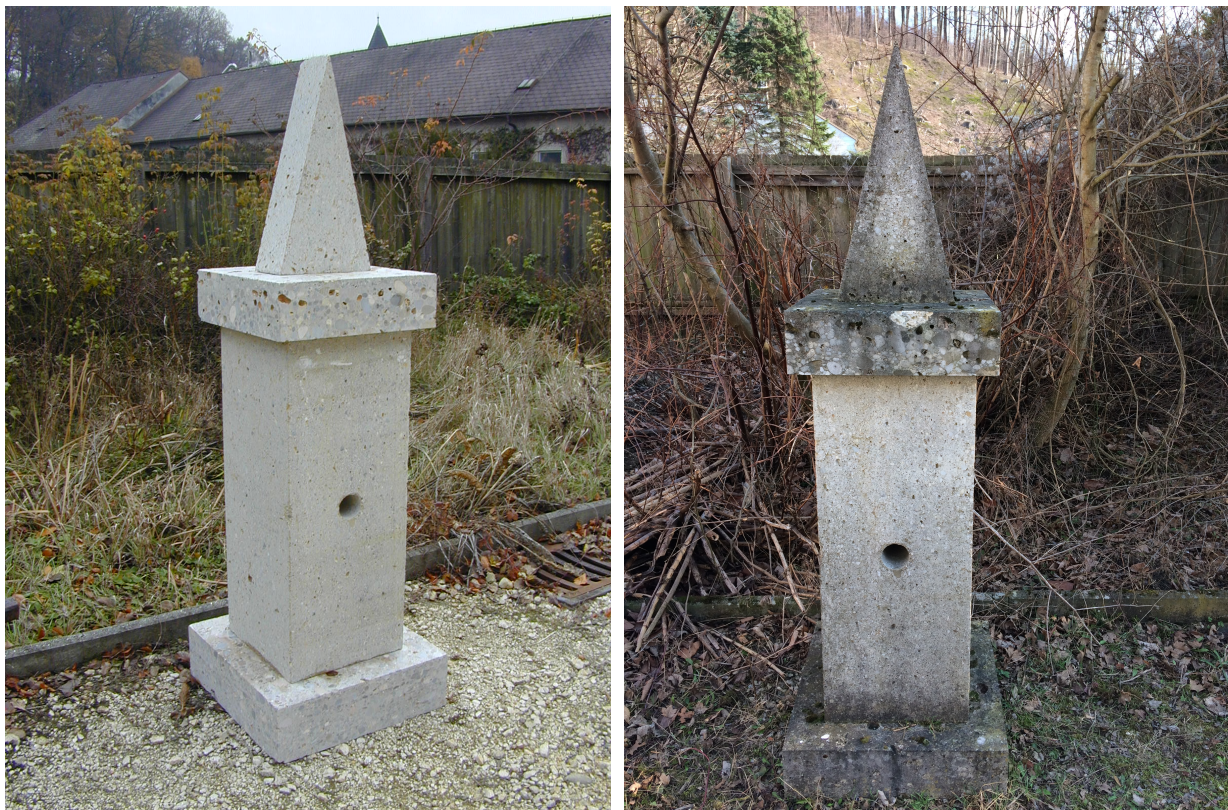
Abb. 4 Lindabrunner Konglomerat (links: zu Expositionsbeginn 2003; rechts: nach knapp 14 Jahren freier Exposition)
