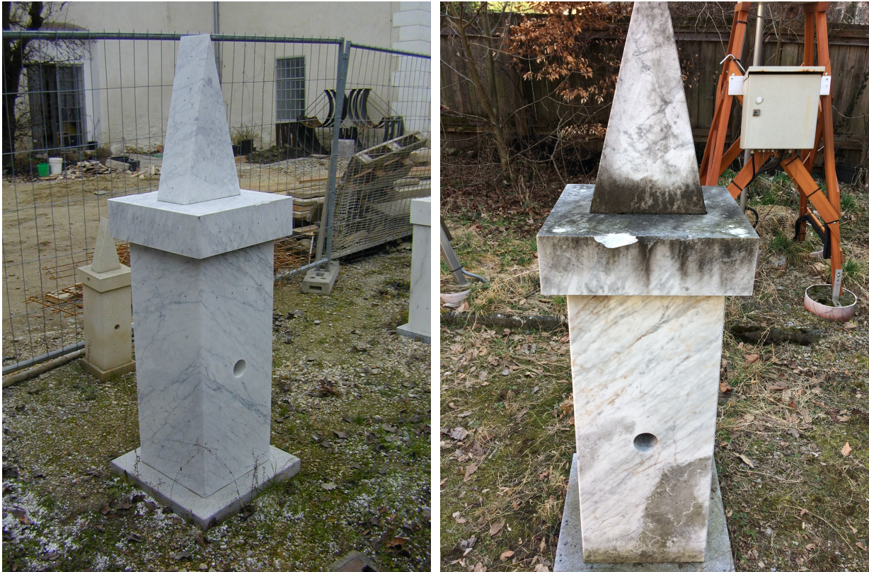
Abb. 6 Carrara Marmor (links: zu Expositionsbeginn 2003; rechts: nach knapp 14 Jahren freier Exposition)
