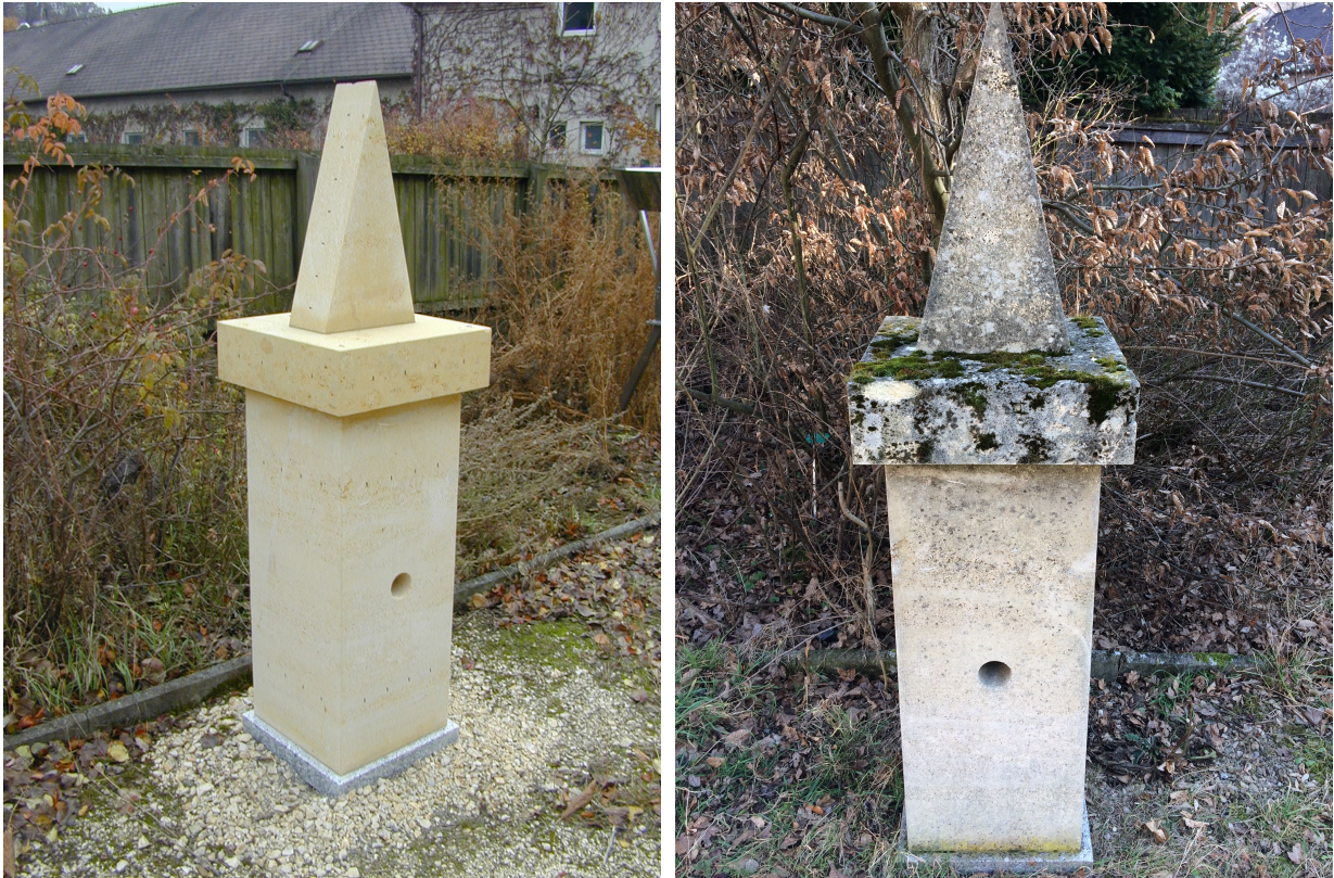
Abb. 3 St. Margarethener Kalksandstein (links: zu Expositionsbeginn 2003; rechts: nach knapp 14 Jahren freier Exposition)
