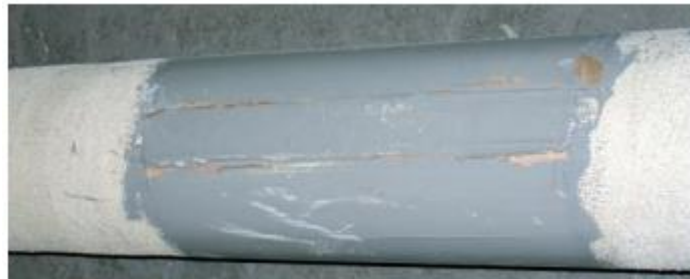
Abbildung 26: Mehrschichtsystem aus FZM-Ummantelung und PUR-Gießharzsystem [71].
