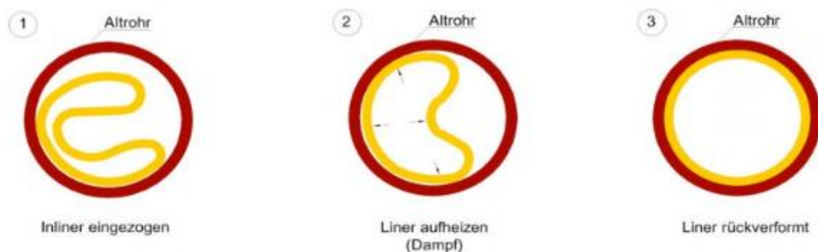
Abbildung 9: Phasen bei der Verwendung verformter Rohre [115].
