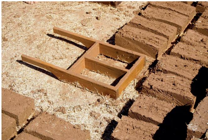
Abb.92: Model bei der Lehmziegelherstellung
