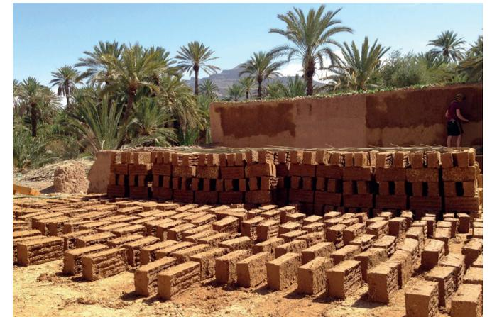
Abb.94: zur Trocknung gestapelte Lehmsteine
