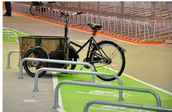
Abb. 43: **spezielle Fahrradbügel für Lastenräder**
