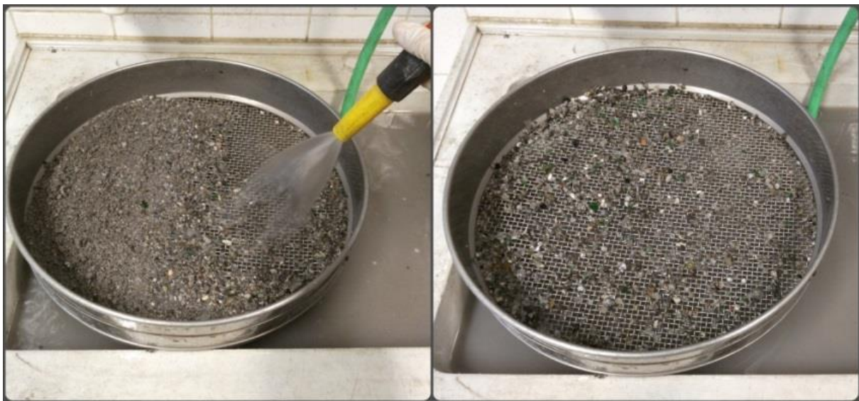
Abbildung 3: Waschen der 4-8 mm Fraktion
