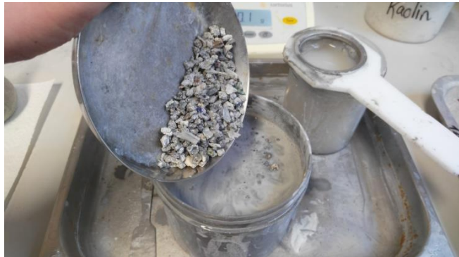
Abbildung 8: Aufgabegut und Schwertrübe während der Dichtesortierung
