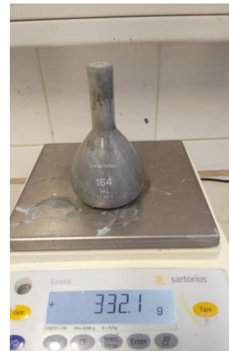
Abbildung 6: Dichtemessung der Schwertrübe
