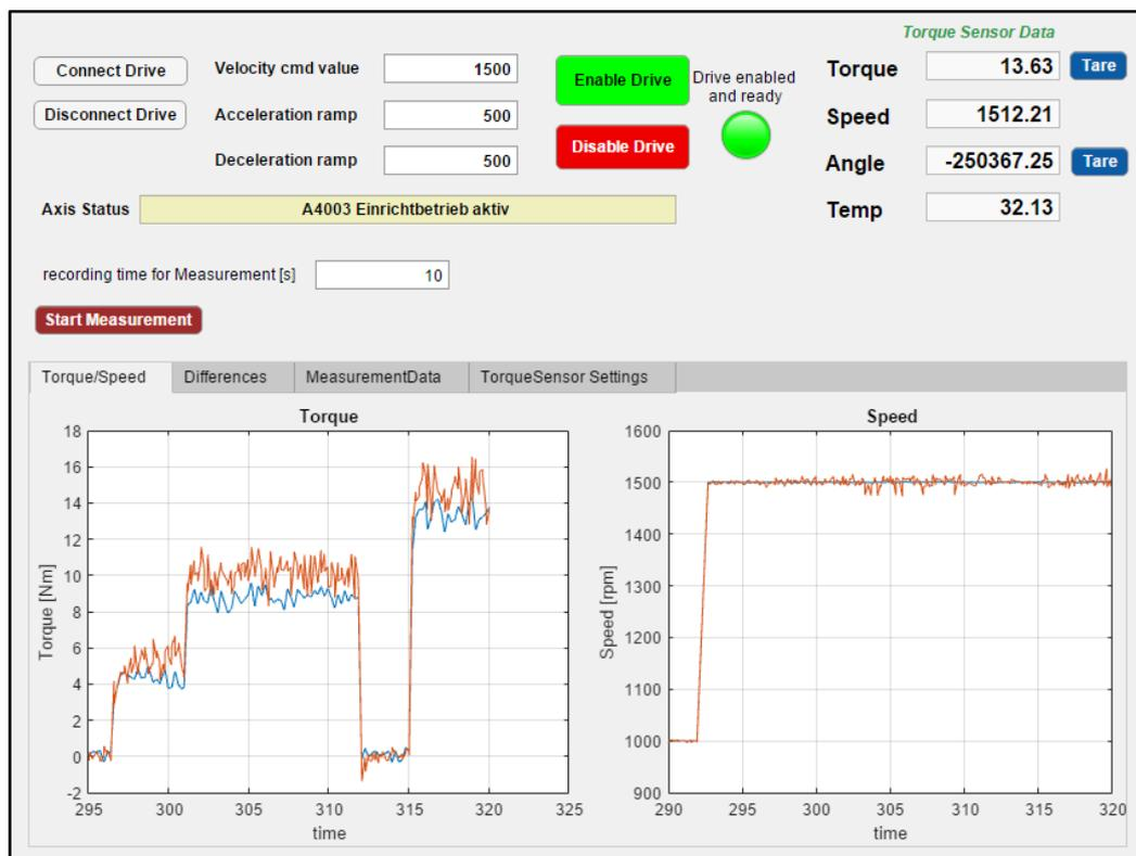
**Abbildung 3.6:** Grafische Benutzeroberfläche für die Bedienung der Lastmaschine und des Drehmomentensors, welche in *Matlab* erstellt wurde.
