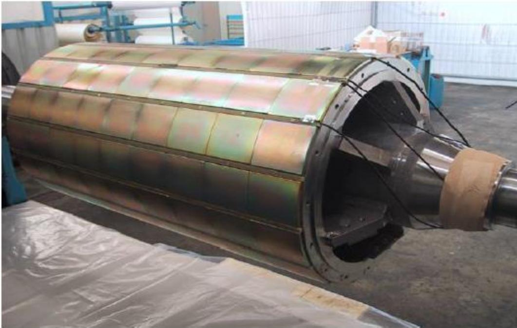
*Abb 4.2.2.1: Werkbild der Fa. Elin EBG eines Läufers mit Permanentmagneten vor dem Bandaagieren
