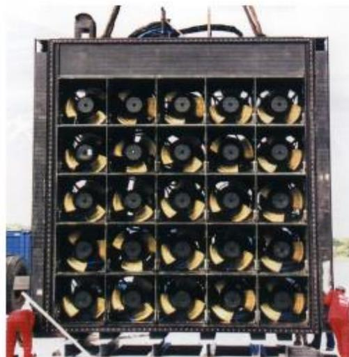
Abb 3.5.1.8: HYDROMATRIX® - Modul in Schiffschleuse Freudenau, Technische Daten (Quelle: HYDROMATRIX® - Technologie bei bestehenden Stauanlagen, S.49, Prenner.R)
