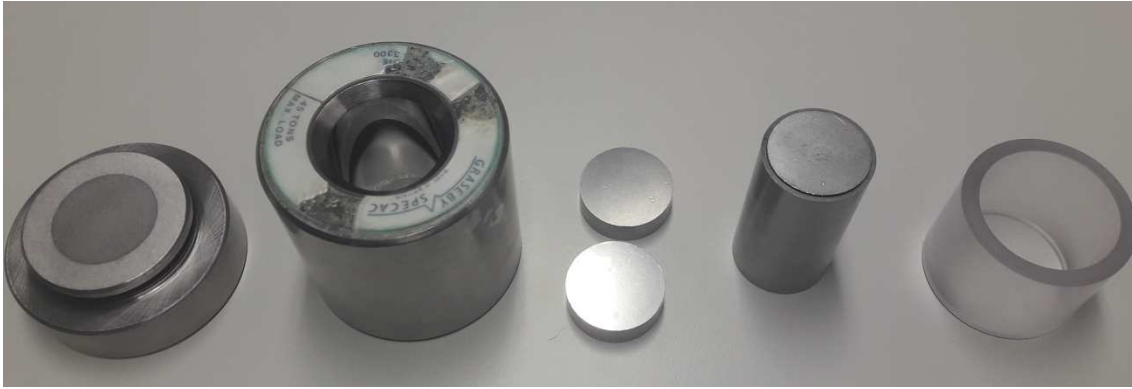
Abbildung 14: Die für die Herstellung eines gepressten Pellets benötigten Werkzeuge. Von links nach rechts handelt es sich um die Bodenplatte, die Stahlhülse, die beiden Hülsenstempel, den Pressstempel und die Kunststoffhalterung.
