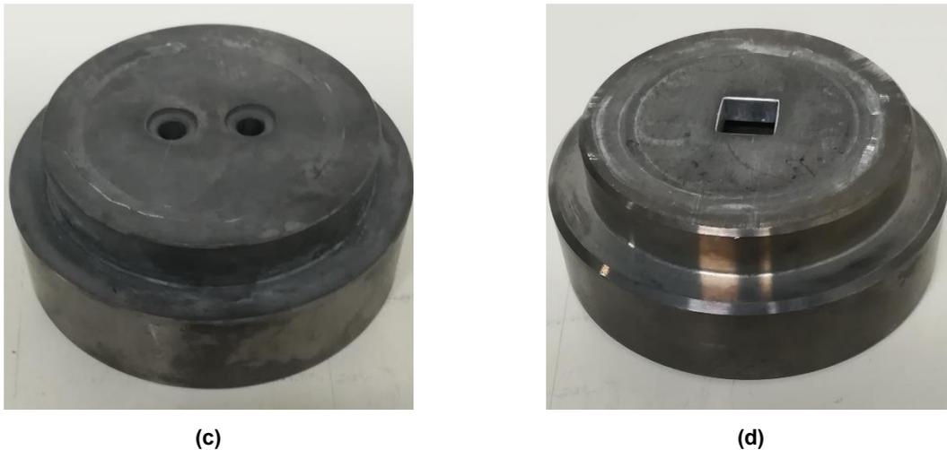
**Figure 16: Used die geometries: (a) RW-die, (b) W10-die, (c) W5-die and (d) QW-die.**
