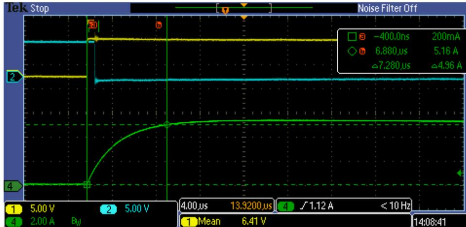
Abbildung 2.9: Der Schaltvorgang von *Artificial* auf *Real Load* mit ca. 600 ns Zeitspanne, in der über beide Loads Strom geleitet wird. Blau: Signallinie für die Artificial Load. Gelb: Signallinie für die Real Load. Grün: Stromverlauf über die Real Load.
