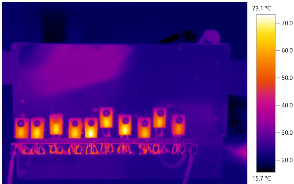
Abbildung 1.4: Aufnahme der Bauteile der Leistungselektronik mit einer Wärmebildkamera im Rahmen von Tests der Wasserkühlung.
