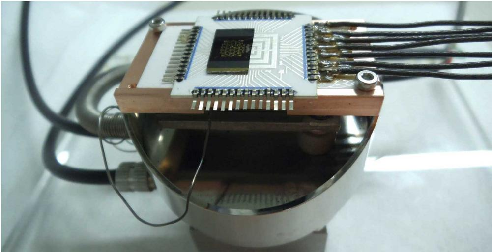
**Abbildung 3.11:** Der Heizaufbau besteht aus dem Heiztisch und einem Kupferaufsatz. Die Probe wurde auf eine Keramikleiterplatte geklebt und an den Kupferaufsatz angeschraubt. Der Temperaturfühler ist zwischen Heizwendel und Kupferaufsatz befestigt (Bildmitte).
