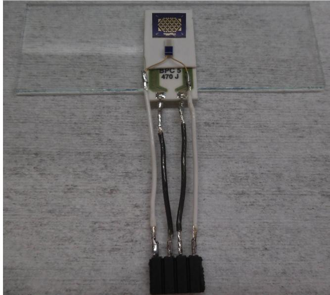
**Abbildung 3.17:** Heizelement mit der Probe. Die zwei inneren Pins werden für die Leistungszufuhr zum Heizelement verwendet und die zwei äußeren Pins dienen zur Temperaturkontrolle mittels PT100 Normwiderstand.
