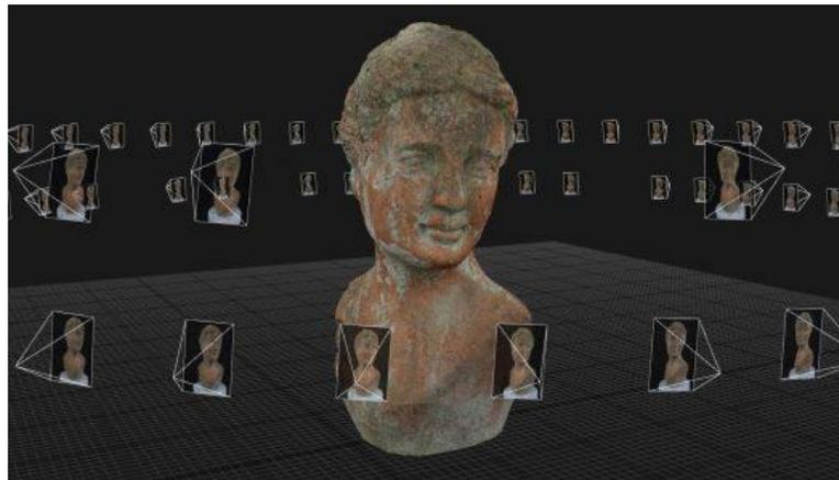
Abbildung 21: 3D Digitalisierung mit Hilfe von Photogrammetrie [46]
