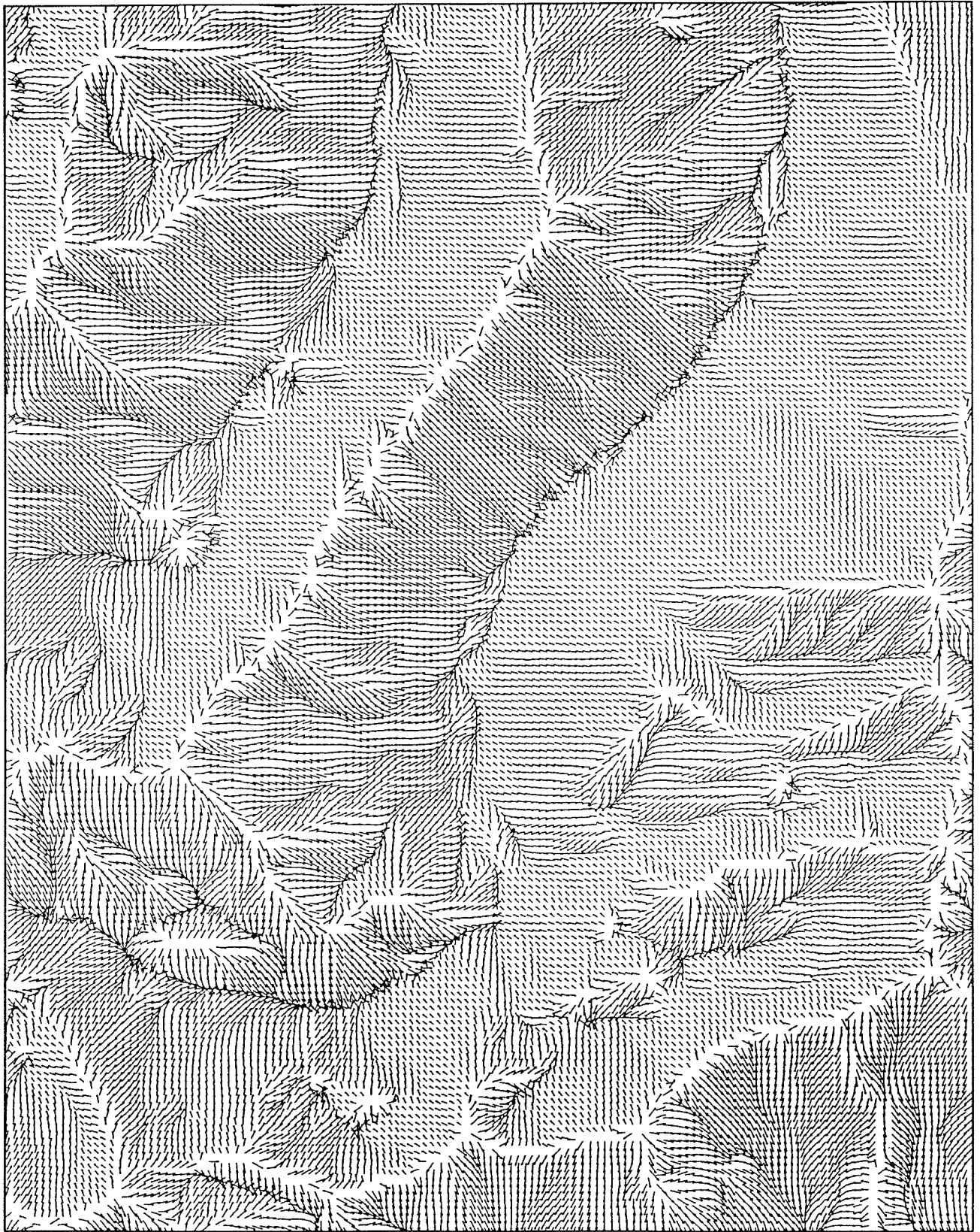
Abb. 4-9: Vektorenlänge abhängig von der Oberflächenhelligkeit bei Beleuchtung des Geländes aus Nordwest unter einer Zenitdistanz von 50 gon
