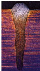
Abbildung 3.6: Schlibbild einer Tiefschweißung
