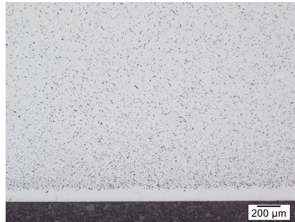
50x Vergrößerung, 5 Sekunden Ätzung nach Murakami
