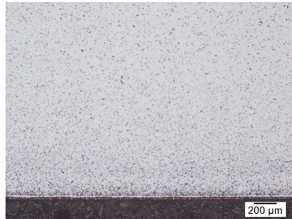
50x Vergrößerung, 5 Sekunden Ätzung nach Murakami
