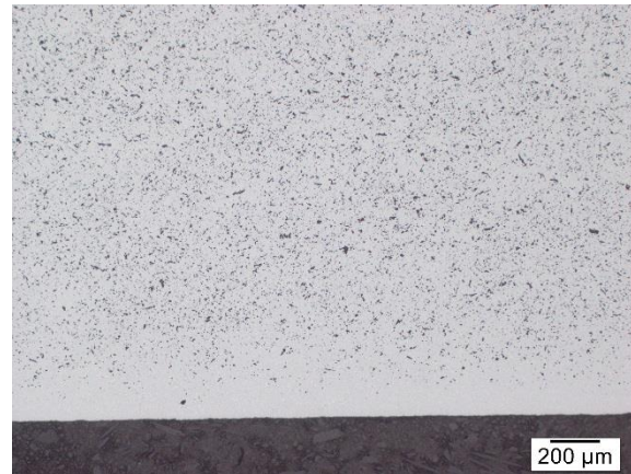
50x Vergrößerung, 5 Sekunden Ätzung nach Murakami
