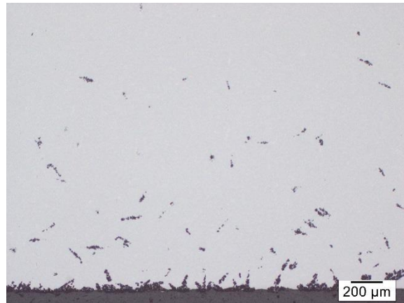
50x Vergrößerung, 5 Sekunden Ätzung nach Murakami
