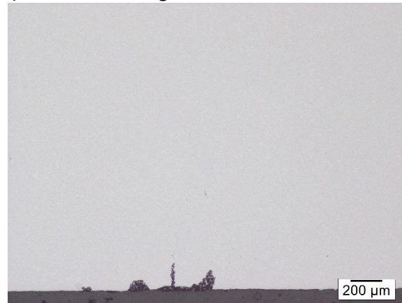
50x Vergrößerung, 5 Sekunden Ätzung nach Murakami
