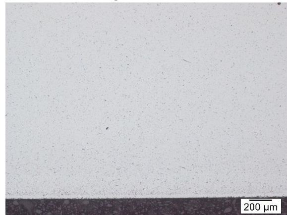
50x Vergrößerung, 5 Sekunden Ätzung nach Murakami
