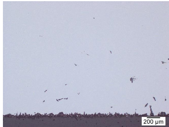
50x Vergrößerung, 5 Sekunden Ätzung nach Murakami
