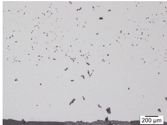
50x Vergrößerung, 5 Sekunden Ätzung nach Murakami
