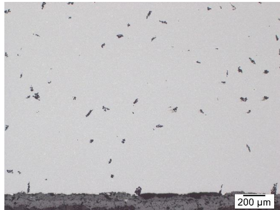
50x Vergrößerung, 5 Sekunden Ätzung nach Murakami
