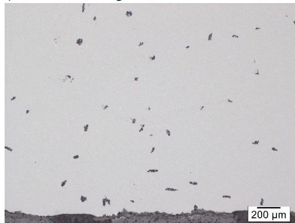
50x Vergrößerung, 5 Sekunden Ätzung nach Murakami
