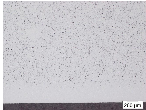
50x Vergrößerung, 5 Sekunden Ätzung nach Murakami
