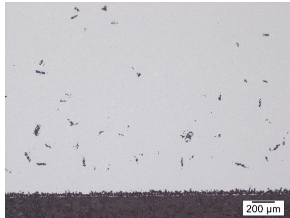
50x Vergrößerung, 5 Sekunden Ätzung nach Murakami
