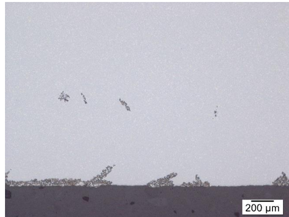
50x Vergrößerung, 5 Sekunden Ätzung nach Murakami
