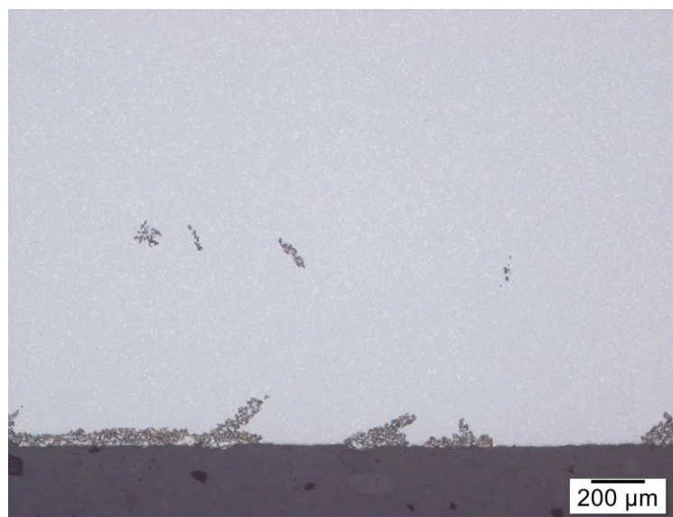
Abbildung 102: \eta -Carbidbildung bedingt durch lokale Entkohlung am \text{Al}_2\text{O}_3 -Filz bei HM6
