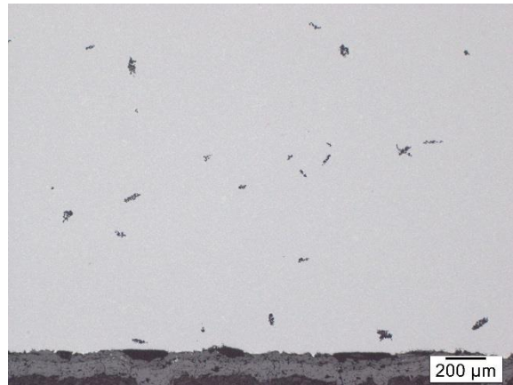
50x Vergrößerung, 5 Sekunden Ätzung nach Murakami
