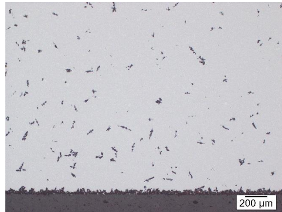
50x Vergrößerung, 5 Sekunden Ätzung nach Murakami
