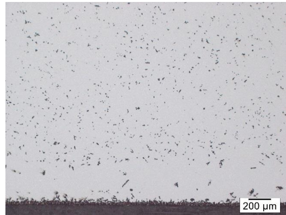
50x Vergrößerung, 5 Sekunden Ätzung nach Murakami
