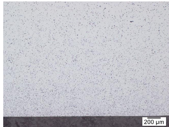
50x Vergrößerung, 5 Sekunden Ätzung nach Murakami
