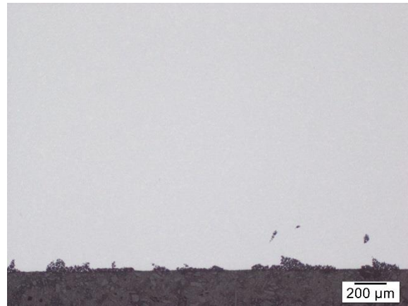
50x Vergrößerung, 5 Sekunden Ätzung nach Murakami
