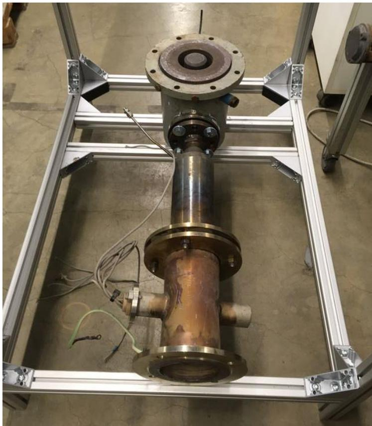
Luftherhitzer und Düsenboden auf dem Gerüst eingehängt.
