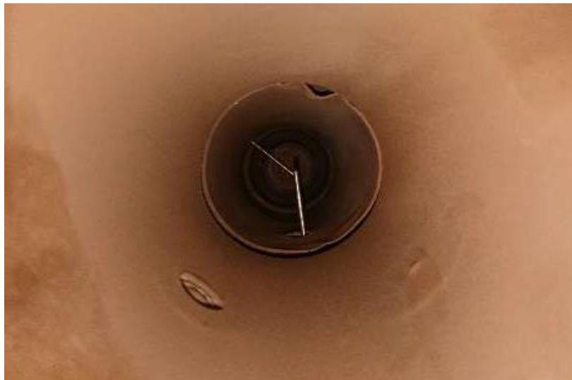
**Abbildung 25. Einbau eines Pt 100-Elemente indie Reaktorwand.**
