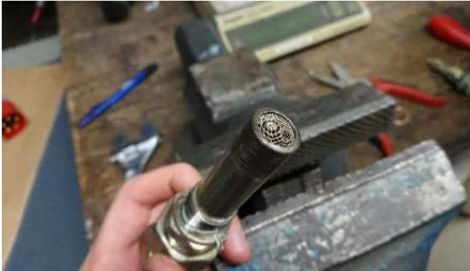
**Abbildung 26. Schutzhülse mit neuem Gitter.**
