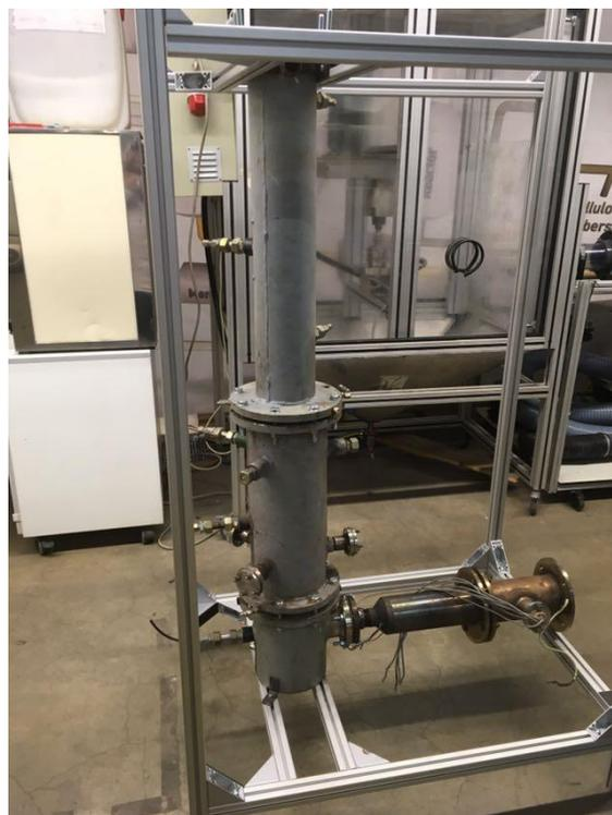
Abbildung 15. Wirbelschichtreaktor für thermochemische Wärmespeicherung.
