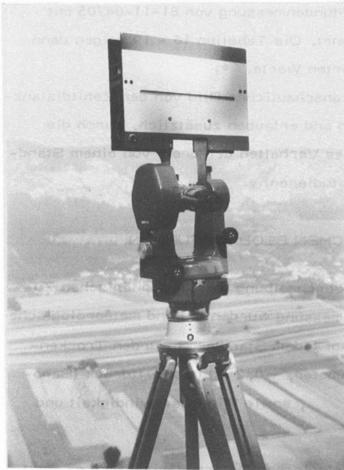
Abb. 60 (KERN DKM2A mit auf- gesetzter Spezialzieltafel)
