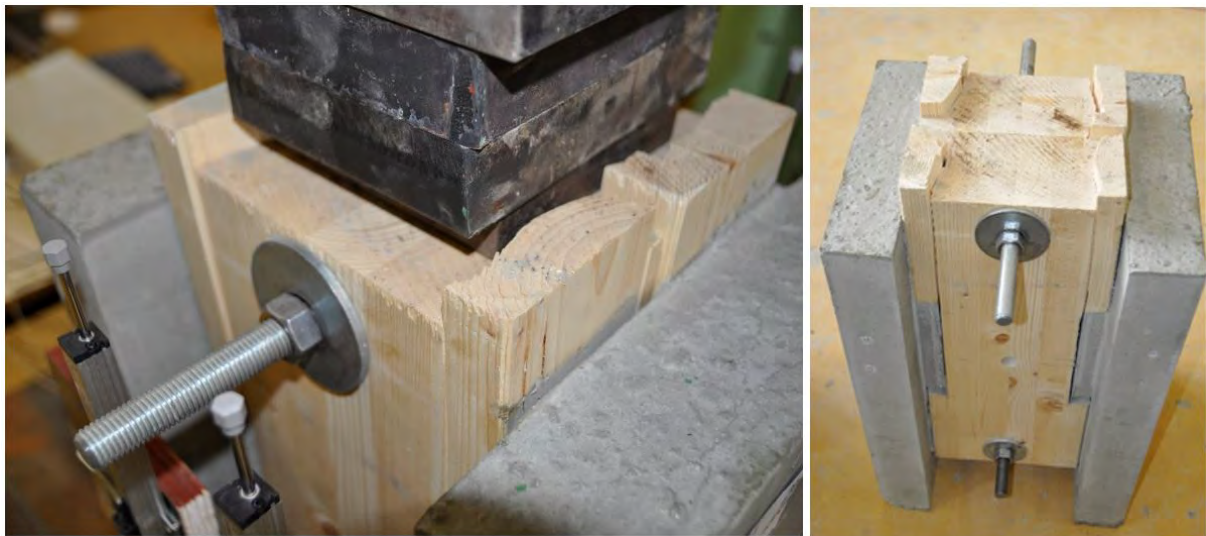
Abb. 5.11: Scherversagen der Holz-Beton-Verbindung, [4]
