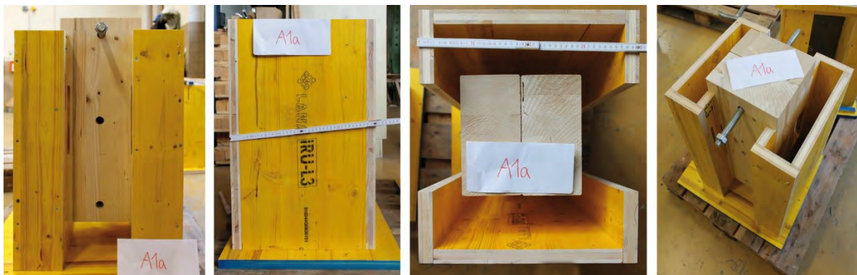
Abb. 5.6: Schalungsaufbau der Holzelemente, [24], [39]
