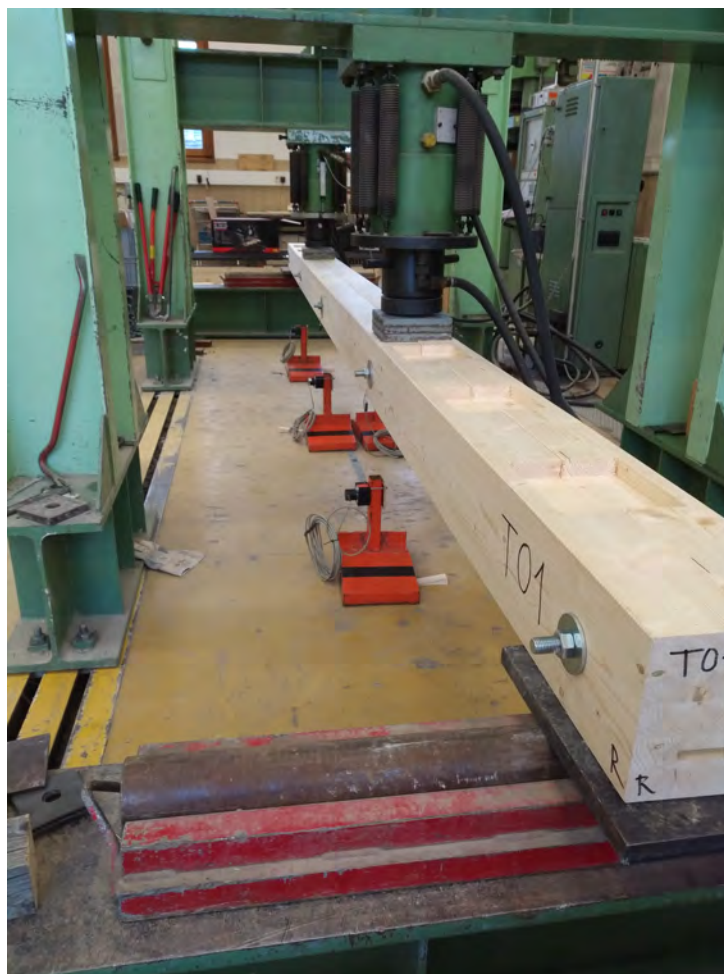
Abb. 8.3: Versuchsanordnung zur Bestimmung des E-Moduls
