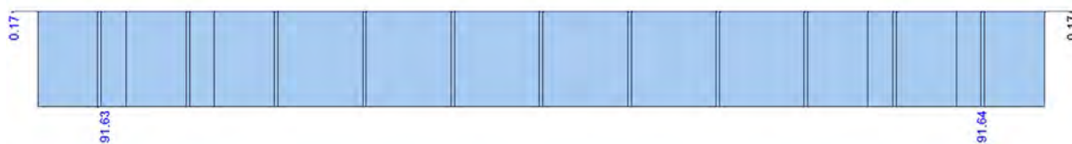
Abb. A.43: Normalkraftverlauf im Holzträger beim Träger mit zwei Kerfen Nutzungskategorie B
