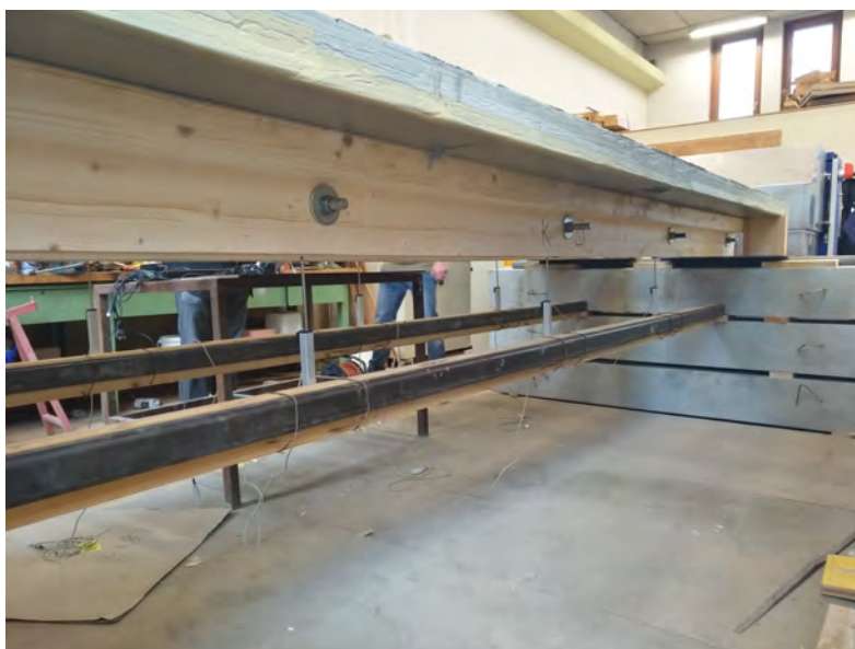
Abb. 7.27: Lage der Messsensoren an den Trägern K3 und K4
