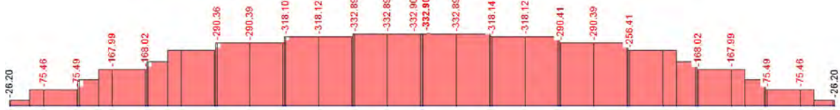
Abb. A.10: Normalkraftverlauf in der Betonplatte beim Träger mit sechs Kerven Nutzungskategorie C5
