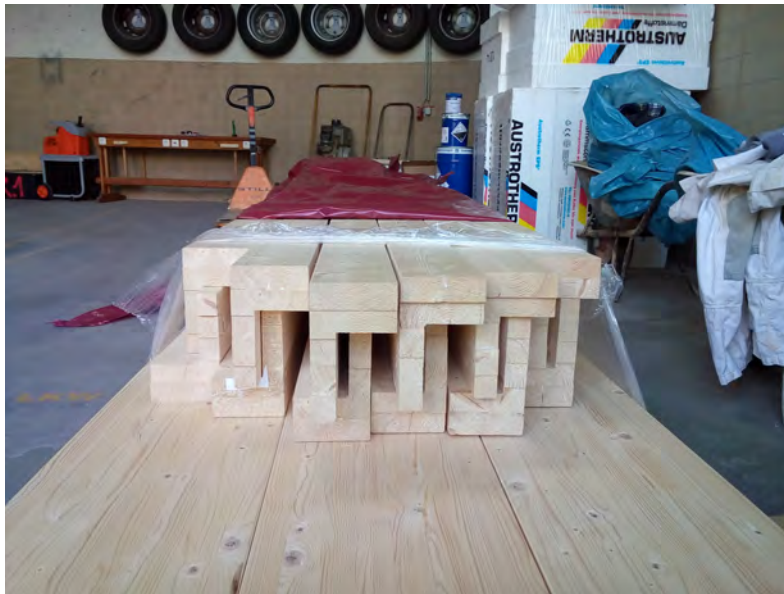
Abb. 7.15: Gelieferte Holzteile für die Herstellung der Langzeitträger
