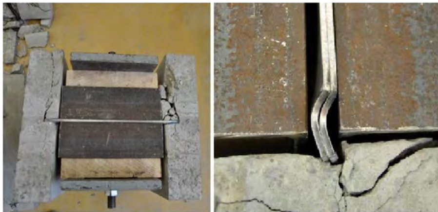
Abb. 5.12: Versagen des Betons und Beulen des Stahlblechs bei gerader Puzzleleiste, [4]
