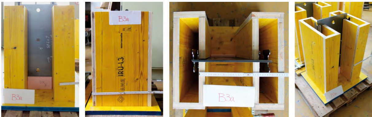
Abb. 5.7: Schalungsaufbau der Stahlelemente, [24], [39]
