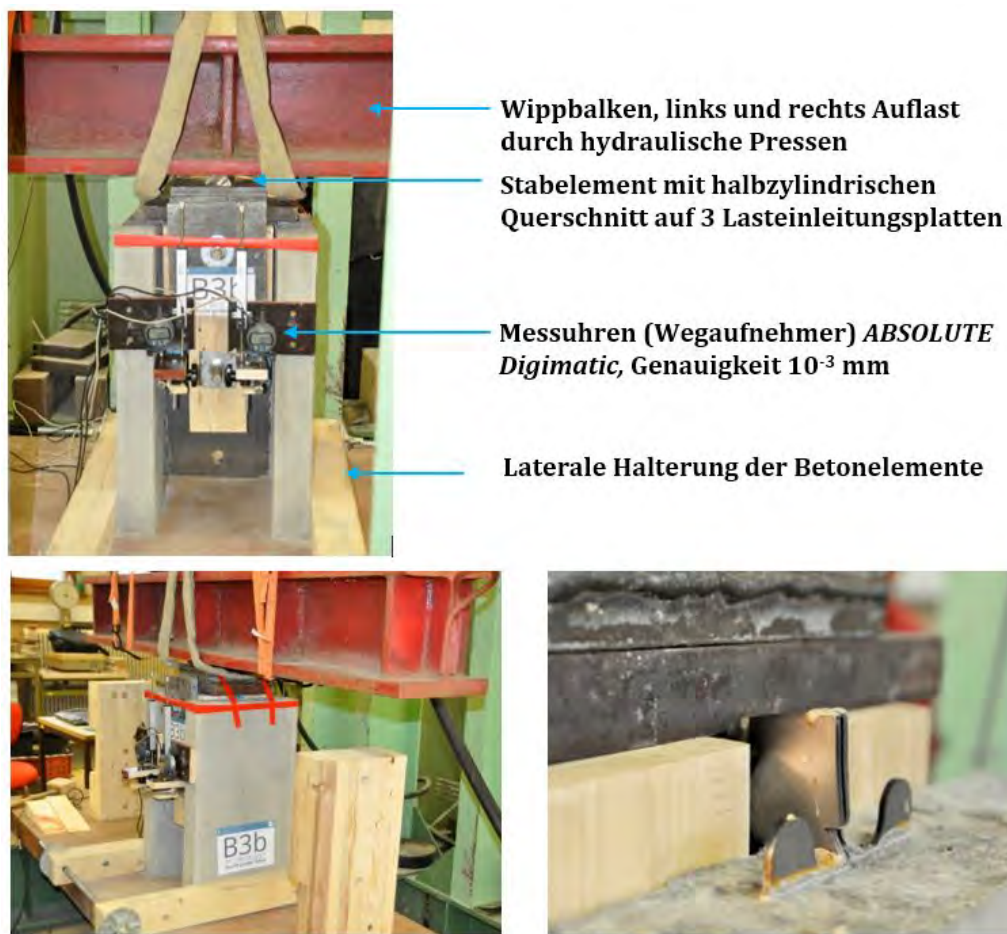
Abb. 5.10: Versuchsaufbau für den Stahl-Beton Probekörper, [4]
