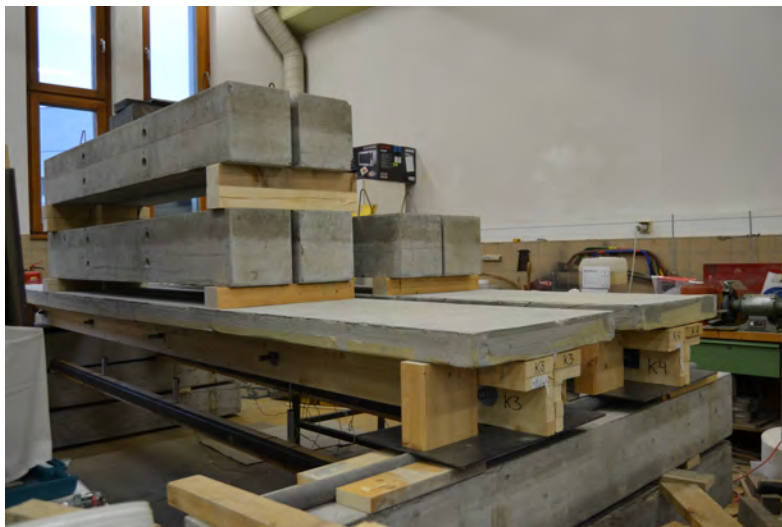
Abb. 7.26: Versuchsaufbau mit aufgelegter Belastung, K3 links und K4 rechts
