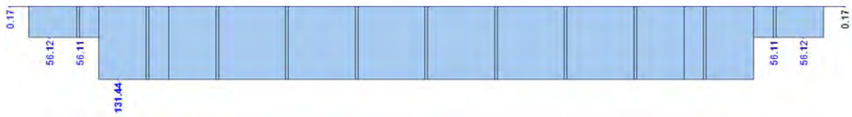
Abb. A.34: Normalkraftverlauf im Holzträger beim Träger mit vier Kerven Nutzungskategorie C5
