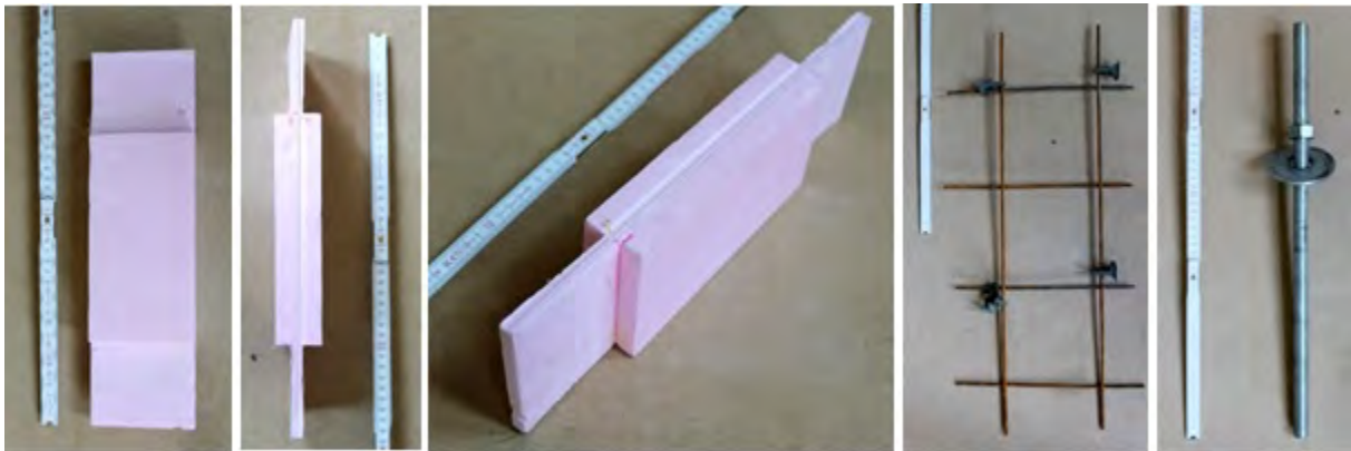
Abb. 5.8: v.l.n.r.: Styrodurelement, Bewehrungsmatte und Gewindestange, [24], [39]
