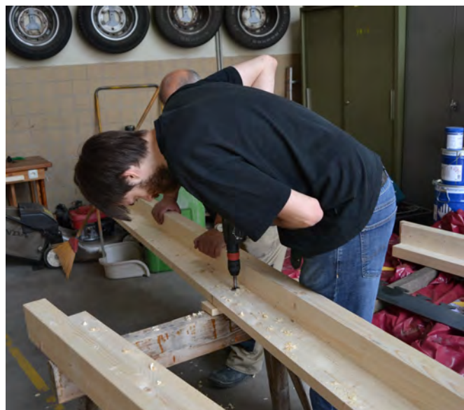
Abb. 7.16: Einbohren der Löcher für die Gewindestangen
