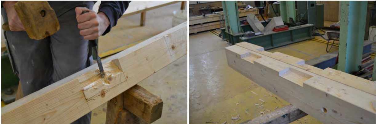
(a) Ausstemmen der Kerbe mittels Hammer und Stemmeisen
