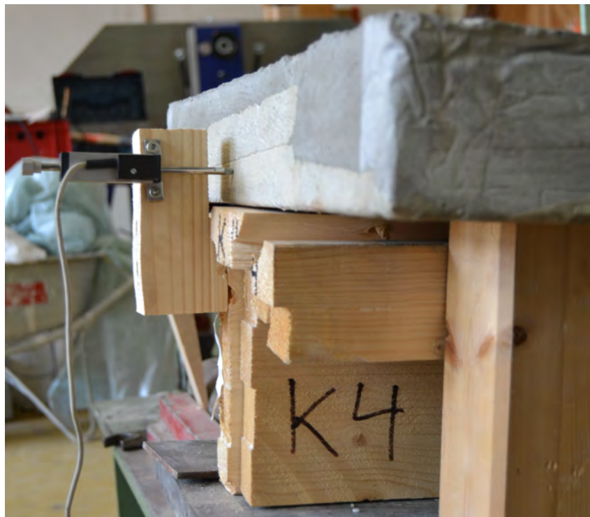
Abb. 9.17: Abscheren des Holzes im Bereich der Stirnseite aufgrund des Schubversagens der Kerven
