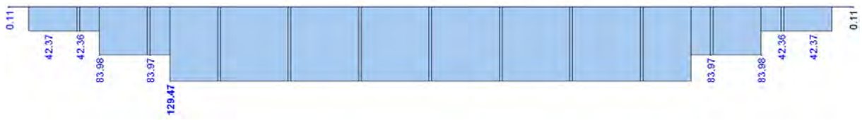
Abb. A.7: Normalkraftverlauf im Holzträger beim Träger mit sechs Kernen Nutzungskategorie B
