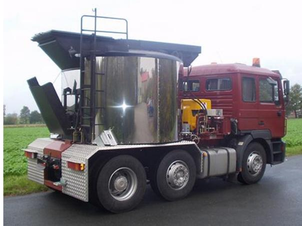
Abbildung 7: Transportkocher mit vertikalem Rührwerk [12]
