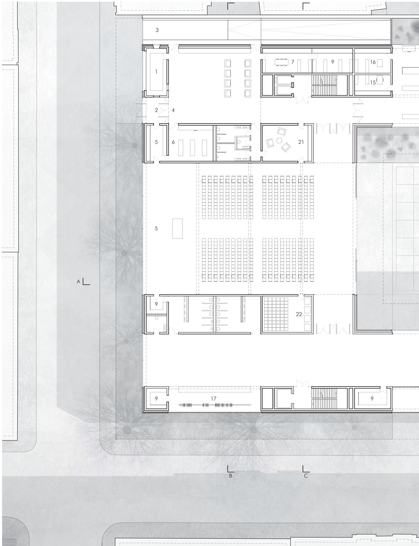
1 Portier 2 Personenschleuse 3 PKW-Schleuse 4 Foyer 5 Sicherheitsschalter und Erste Hilfe 6 Post- und Botenstelle 7 Aufenthaltsraum des Personals 9 Lager 10 Sicherheitsschalter 20 Küche 21 Rückzugsraum des Botschafters 22 Sessellager
