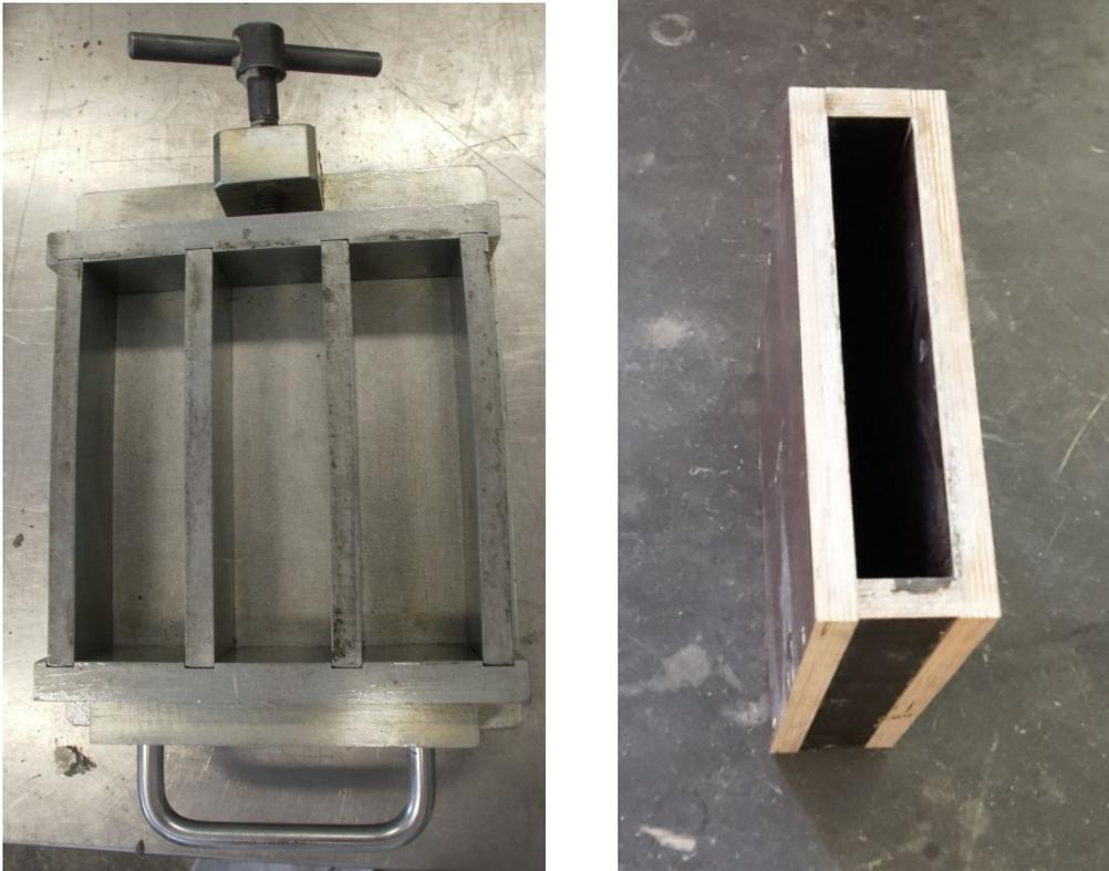
**Abbildung 3.4:** Prismen-Schalungsform für Festbetonprüfungen (links), Schalungsform für Brandversuche (rechts)
