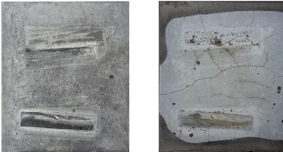
**Abbildung 8.117:** Oberfläche der Brandplatte: Vor Brandversuch (links); nach Brandversuch (rechts)
