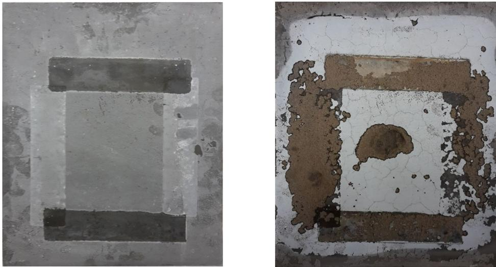
**Abbildung 8.66:** Oberfläche der Brandplatte: Vor Brandversuch (links); nach Brandversuch (rechts)
