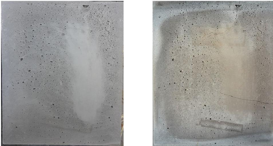
**Abbildung 8.90:** Oberfläche der Brandplatte: Vor Brandversuch (links); nach Brandversuch (rechts)
