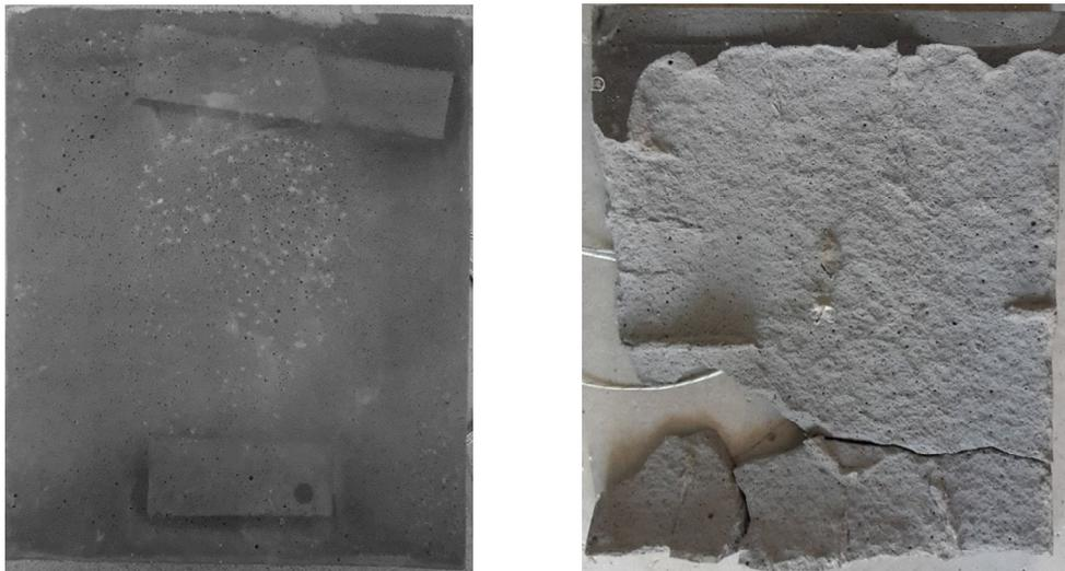
**Abbildung 8.39:** Oberfläche der Brandplatte: Vor Brandversuch (links); nach Brandversuch (rechts)
