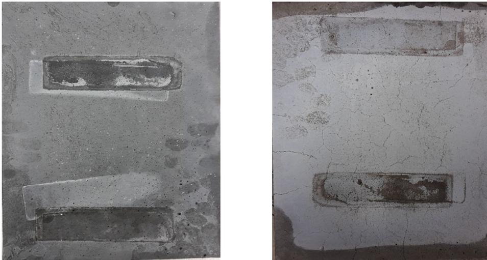
**Abbildung 8.102:** Oberfläche der Brandplatte: Vor Brandversuch (links); nach Brandversuch (rechts)
