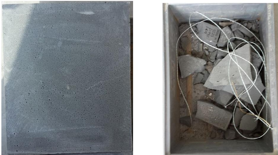
**Abbildung 8.74:** Oberfläche der Brandplatte: Vor Brandversuch (links); nach Brandversuch (rechts)
