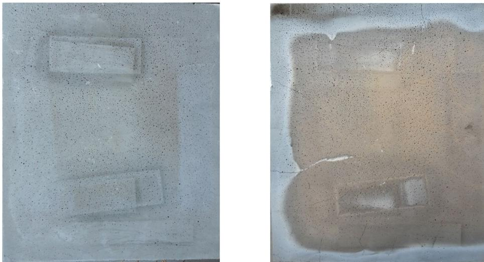
**Abbildung 8.28:** Oberfläche der Brandplatte: Vor Brandversuch (links); nach Brandversuch (rechts)
