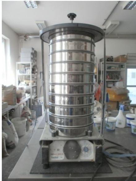
**Abbildung 3.21:** Siebturm mit mechanischem Rüttelgerät
