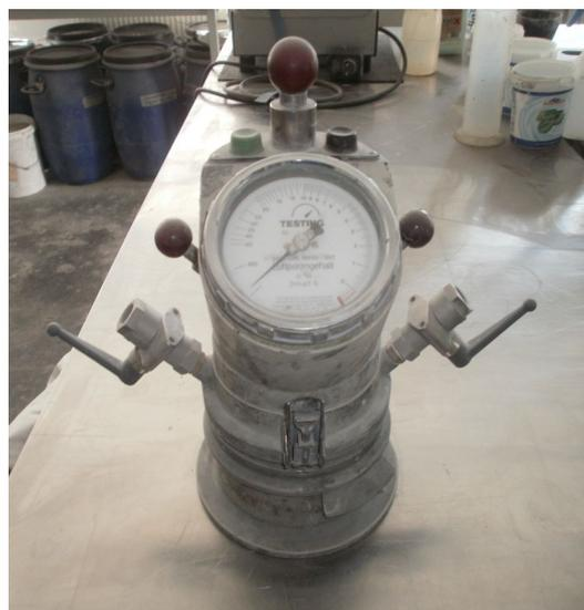
**Abbildung 3.6:** Messgerät zur Ermittlung des Luftgehaltes von Frischbeton (Luftporentopf)
