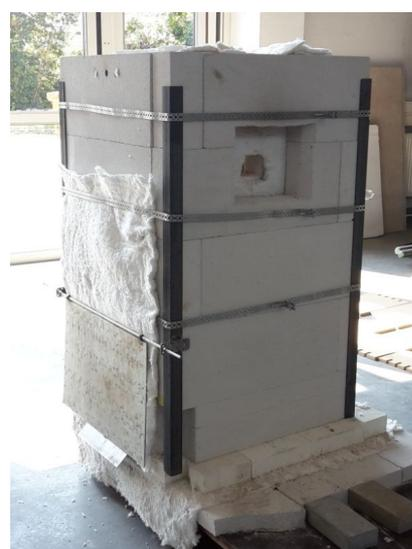
**Abbildung 3.16:** Bau des Versuchsbrandofens
