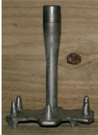
**Abbildung 3.2:** Stiftenwirbler für Eirich Intensivmischer R02 Vac (Rossbacher, Schneider, Kirnbauer, 2010, S. 39)
