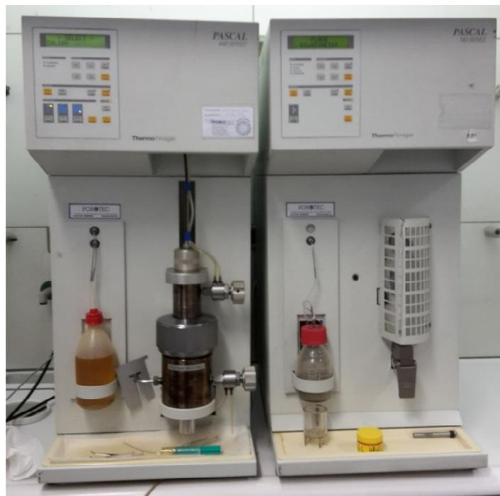
**Abbildung 3.14:** Hochdruckstation PASCAL 440 (links); Niederdruck-Porosimeter PASCAL 140 (rechts)
