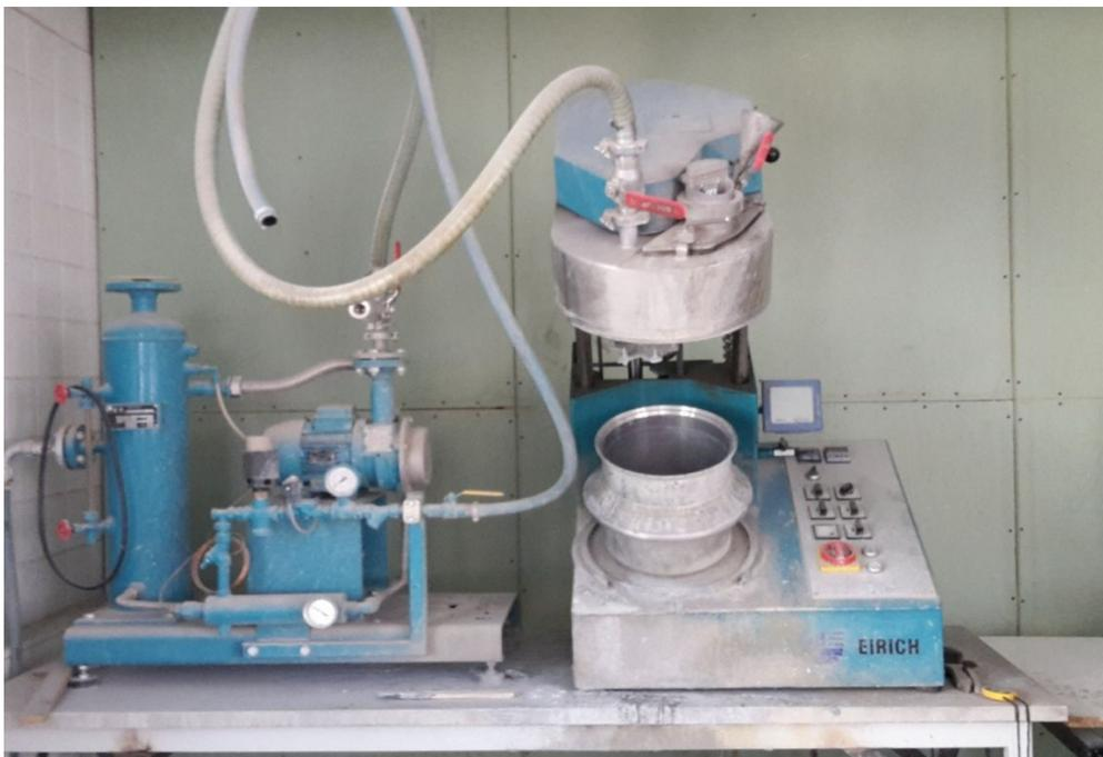
**Abbildung 3.1:** Eirich Intensivmischer R02 Vac (rechts) mit angeschlossener Vakuumanlage (links)
