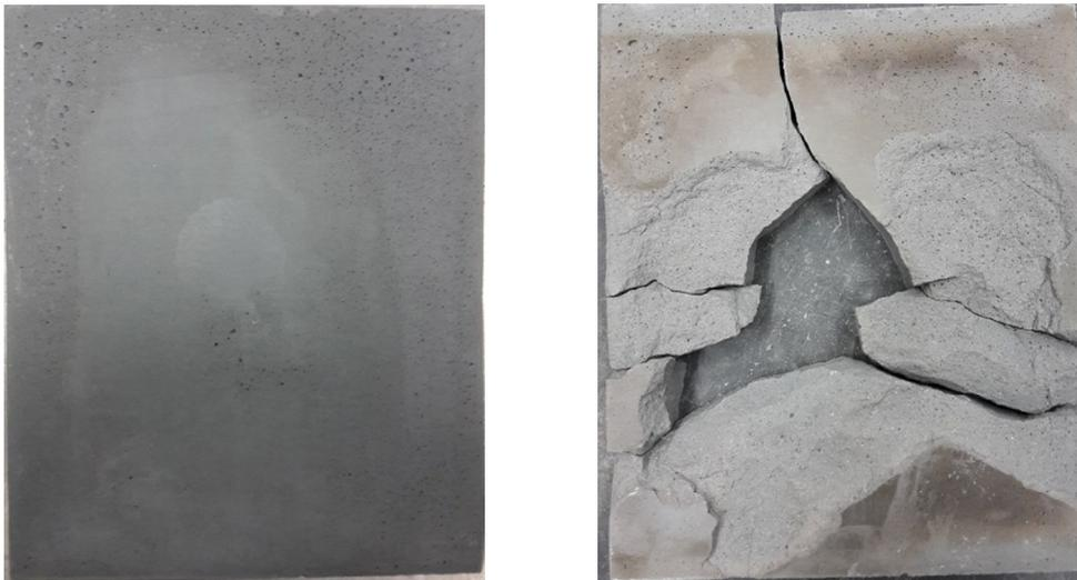
**Abbildung 8.21:** Oberfläche der Brandplatte: Vor Brandversuch (links); nach Brandversuch (rechts)
