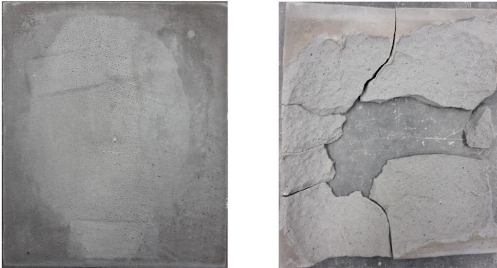
**Abbildung 8.5:** Oberfläche der Brandplatte: Vor Brandversuch (links); nach Brandversuch (rechts)
