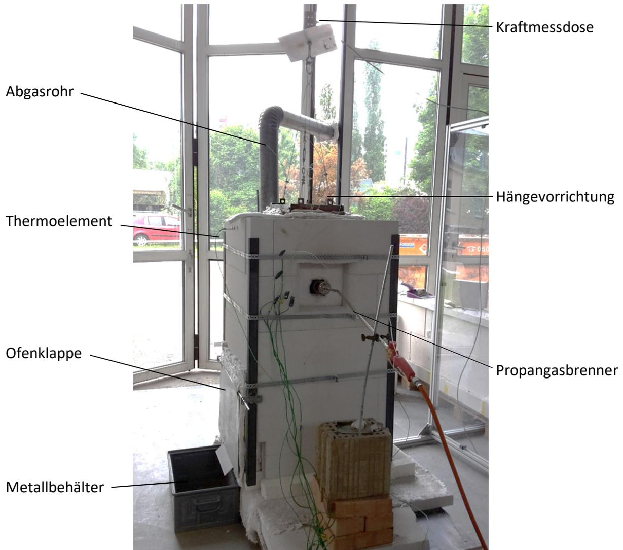
**Abbildung 3.19:** Versuchsaufbau der Brandversuche
