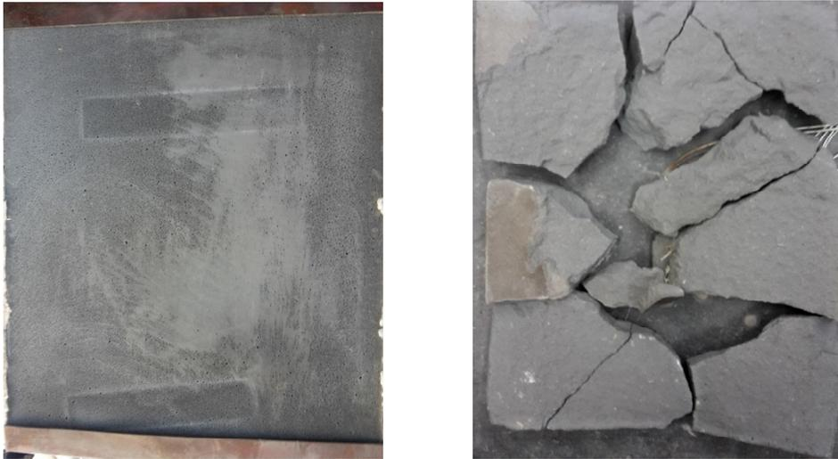
**Abbildung 8.78:** Oberfläche der Brandplatte: Vor Brandversuch (links); nach Brandversuch (rechts)
