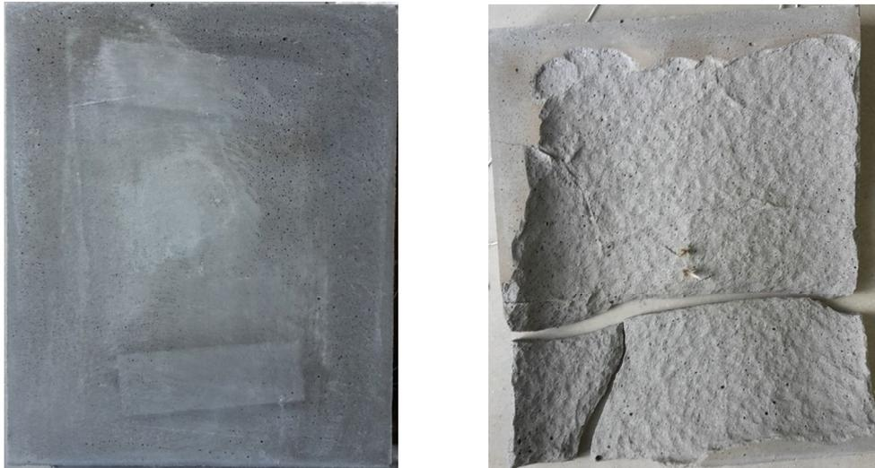
**Abbildung 8.1:** Oberfläche der Brandplatte: Vor Brandversuch (links); nach Brandversuch (rechts)
