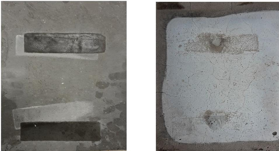
**Abbildung 8.105:** Oberfläche der Brandplatte: Vor Brandversuch (links); nach Brandversuch (rechts)
