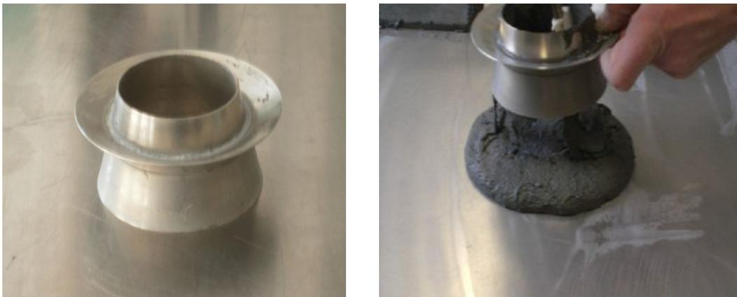
**Abbildung 3.7:** Bestimmung des Ausbreitfließmaßes: Setztrichter (links); Versuchsdurchführung (rechts) (Kirnbauer, 2013, S. 74)
