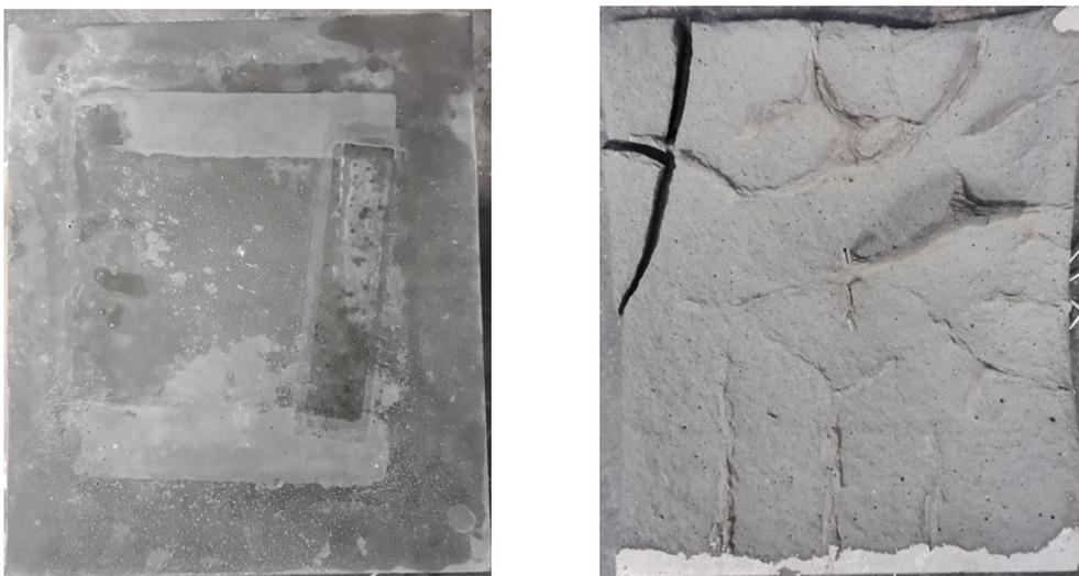
**Abbildung 8.51:** Oberfläche der Brandplatte: Vor Brandversuch (rechts); nach Brandversuch (links)
