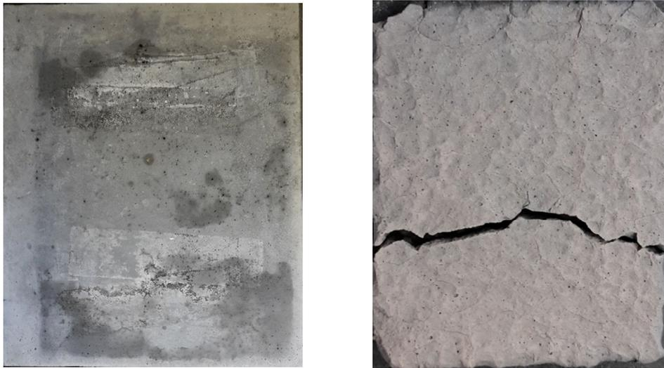
**Abbildung 8.35:** Oberfläche der Brandplatte: Vor Brandversuch (links); nach Brandversuch (rechts)
