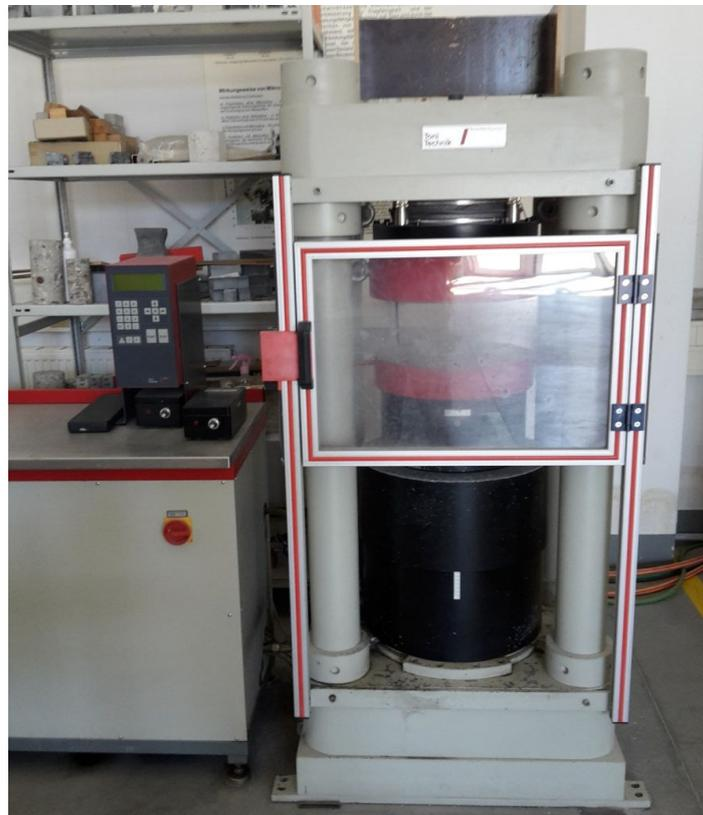
**Abbildung 3.10:** Prüfmaschine der Firma TONI Technik Modell 2040
