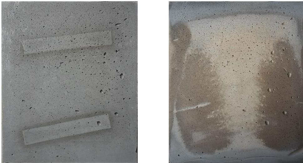
**Abbildung 8.120:** Oberfläche der Brandplatte: Vor Brandversuch (links); nach Brandversuch (rechts)
