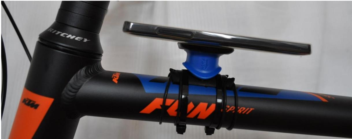
*Abb. 39: Nahaufnahme der Halterung „Quad Lock“ mit angebrachtem Mobiltelefon
