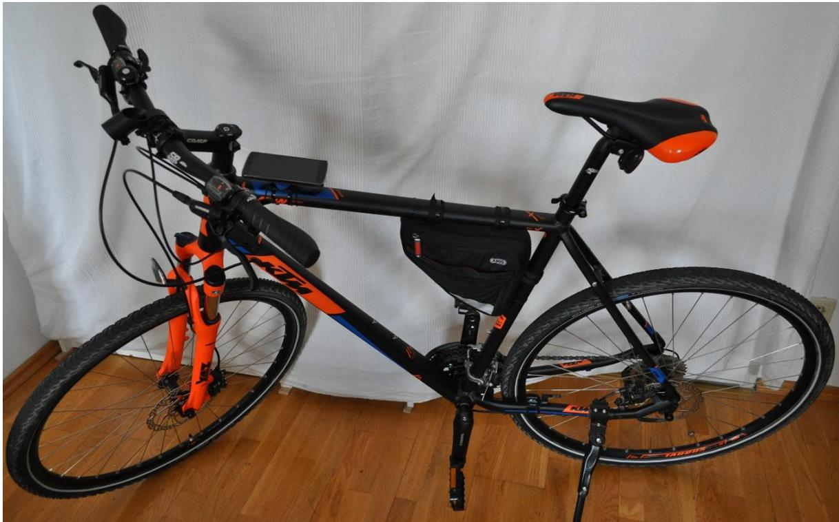
**Abb. 40:** Versuchsfahrrad des Modells „Fun Spirit“ der Marke KTM mit Rahmengröße 60 und 28 Zoll „Tyrago“ Tourenreifen von Schwalbe (Quelle: eigene Aufnahme)
