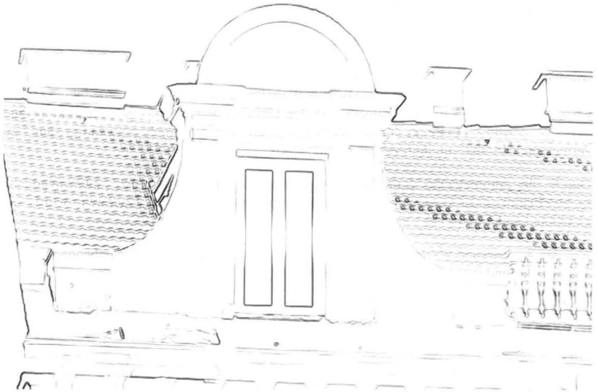
Abbildung 6.13 Kantenhervorhebung durch Sobelfilterung
