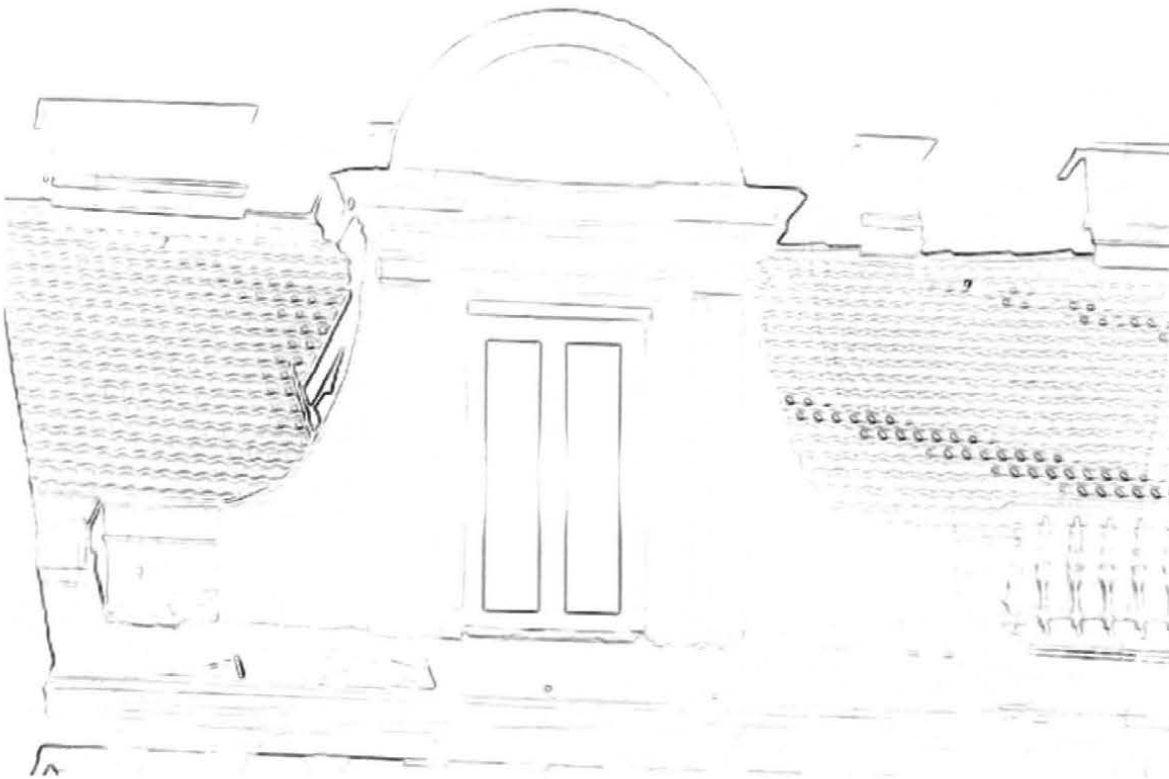
Abbildung 6.15 Kanten hervorhebung durch Kirschfilterung
