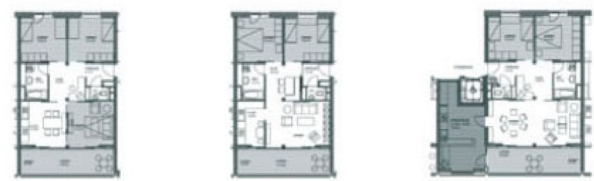
Abbildung 136 Haus Hagen, Wohnungsgrundrisse Variabilität des Wohn-, Ess-, Kochbereiches. Variante mit Schaltraum. (Quelle: Heide Mühlfellner)
