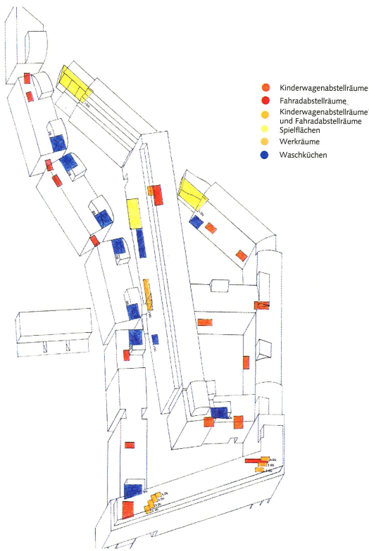
Abbildung 43 Wohnungsergänzungseinrichtungen, Isometrie. Kinderwagen und Fahrrad (rot), Spielräume und -bereiche (gelb), Werkräume (orange), Waschküchen (blau). (Quelle: Christine Zwingl in: Frauenbüro, Magistrat der Stadt Wien: Frauen-Werk-Stadt, 1996)
