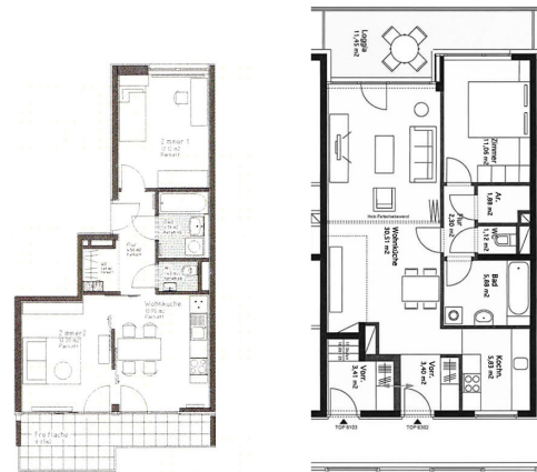
Abbildung 184 Remisenhof Linz Urfahr. Haus Mitte, 49 m 2 Wohnung mit abteilbarem Raum für AlleinzieherIn (Quelle: Marlies Binder)
