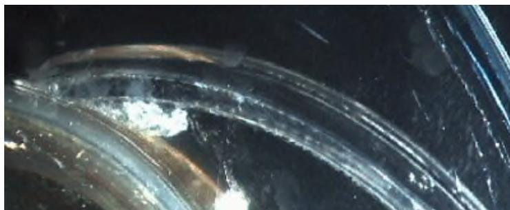
Abbildung 63:  $NPSH_{3\%}$  bei Teillast 2,0 l/s; 60 Hz - Laufrad 2002
