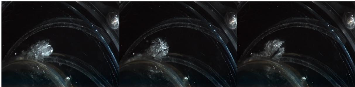
Abbildung 62:  $NPSH_{min}$  bei Teillast 2,0 l/s; 60 Hz - Laufrad 2002
