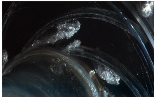
Abbildung 64: NPSH<sub>min</sub> bei Überlast 7,0 l/s; 60 Hz - Laufrad 2002
