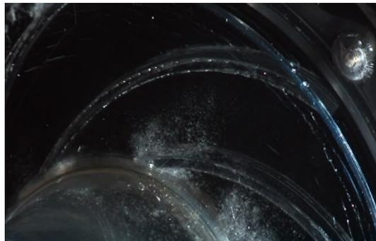
Abbildung 61:  $NPSH_{min}$  bei Teillast 0,25 l/s; 60 Hz - Laufrad 2002
