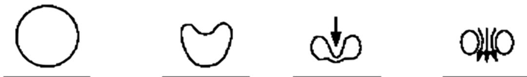
Abbildung 21: Schematische Darstellung der asymmetrischen Implosion einer Kavitationsblase [6]
