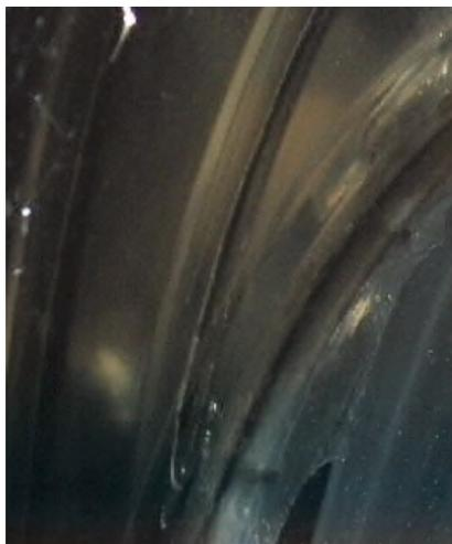
Abbildung 66: NPSH<sub>i</sub> bei Überlast 6,0 l/s; 50 Hz - Laufrad 2007
