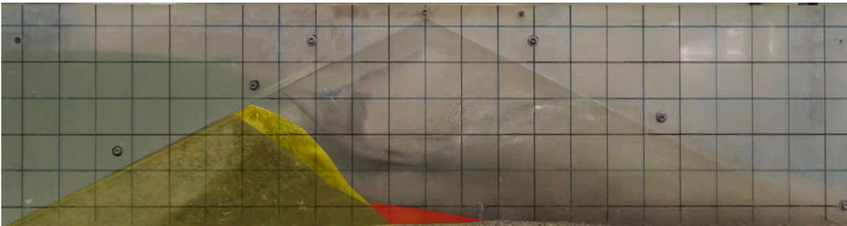
Abbildung 4.50: Plötzliches Nachbrechen der Breschenkrone- Symmetrieebene
