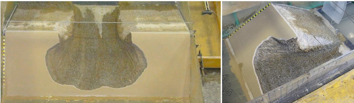
Abbildung 2.9: Sanduhrförmige Endbreschen im Voll- und Symmetriemodell
