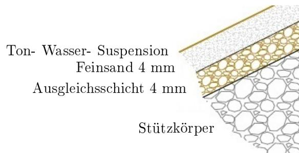
Abbildung 3.2: Aufbau des Dichtungssystems
