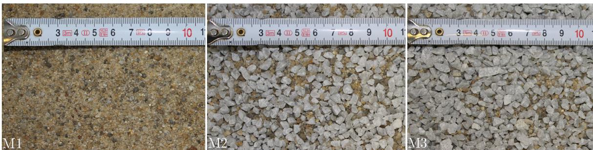
Abbildung 3.3: Verwendete Stützkörpermaterialien
