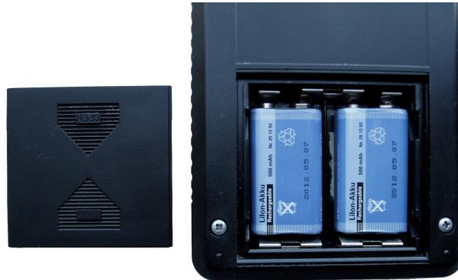
**Abb. 3.5:** Geöffnetes Batteriefach mit zwei eingelegten 9 V Lithium-Ionen-Akkumulatoren.
