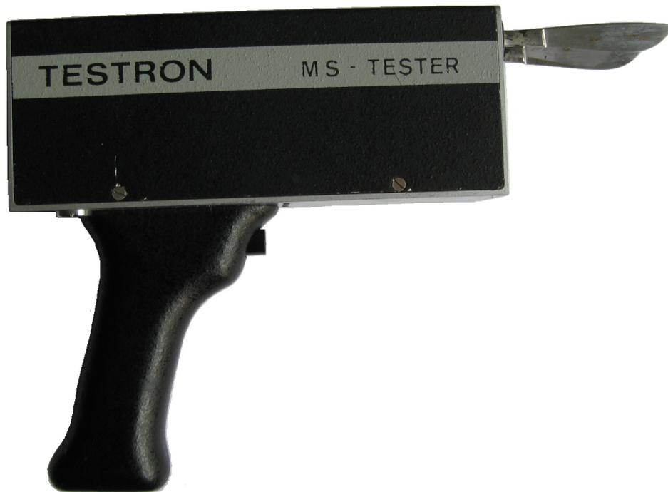
Abb. 2.18: Das Testron-MS-Testgerät in der Seitenansicht.
