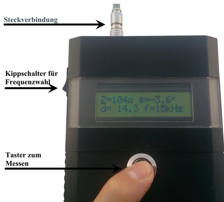
**Abb. 3.4:** Ausschnitt des Geräts mit dem Elektrodenanschluss, dem Display mit einem Messergebnis, dem Taster zum Messen und dem Kippschalter zum Frequenz einstellen (in diesem Fall sind 15 kHz eingestellt).
