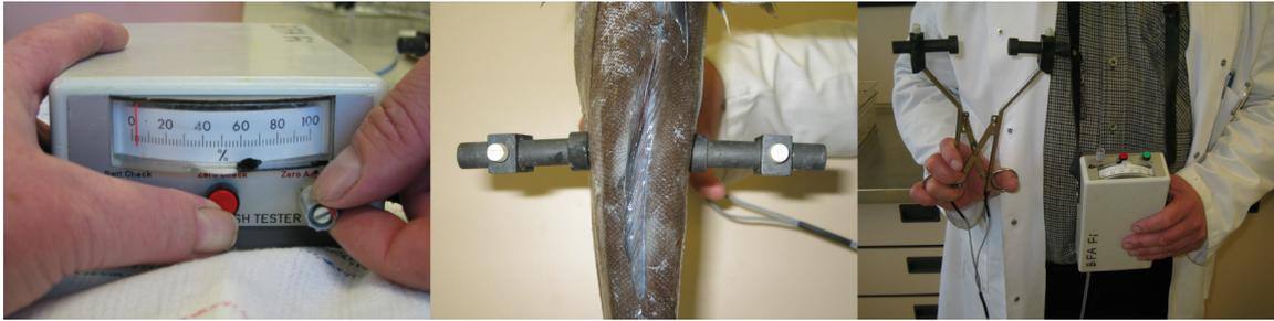
**Abb. 2.15:** Bilder des Intellectron Fischtester VI. Links: Anzeige des Fischtesters. Mitte: Der Fischtester zum Messen angelegt. Rechts: Gesamter Aufbau des Fischtesters. [1]
