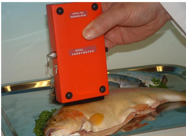
**Abb. 2.21:** Das Torrymeter im Einsatz. [20]
