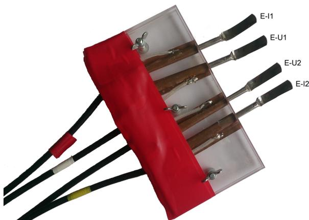
**Abb. 3.7:** Elektrodenhalterung mit flachen Elektroden (geschliffene Löffel) und benannten Elektroden (Stromelektroden E-I und Messelektroden E-U).
