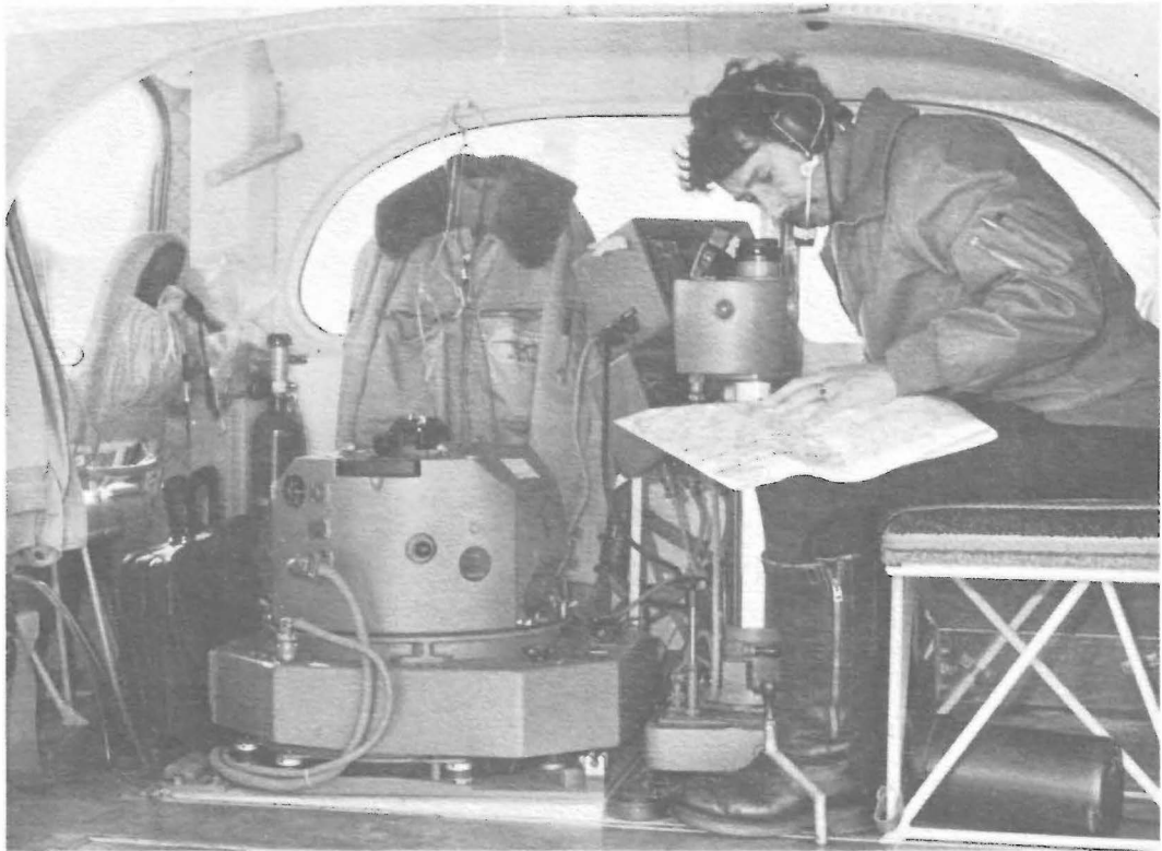
Abbildung 7: Reihenbildkammer WILD RC10 mit Belichtungsmeßeinheit PEM 1 und Navigationsfernrohr NAV2
