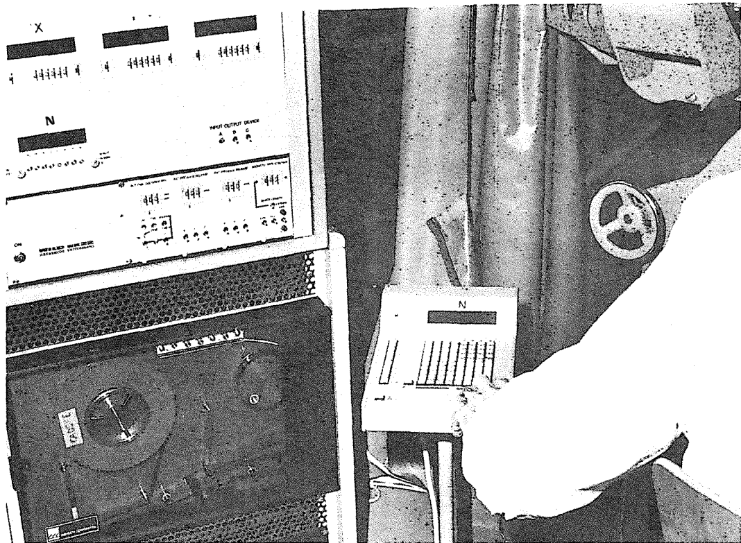
Abbildung 9: Autograph WILD A8 mit Datenerfassungssystem EK22 und Magnetbandstation
