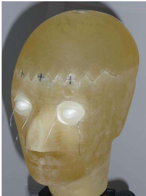
Abb. 4.35: Fertiges Schädelphantom samt Augeneinsätzen (Kevlarfäden sichtbar)
