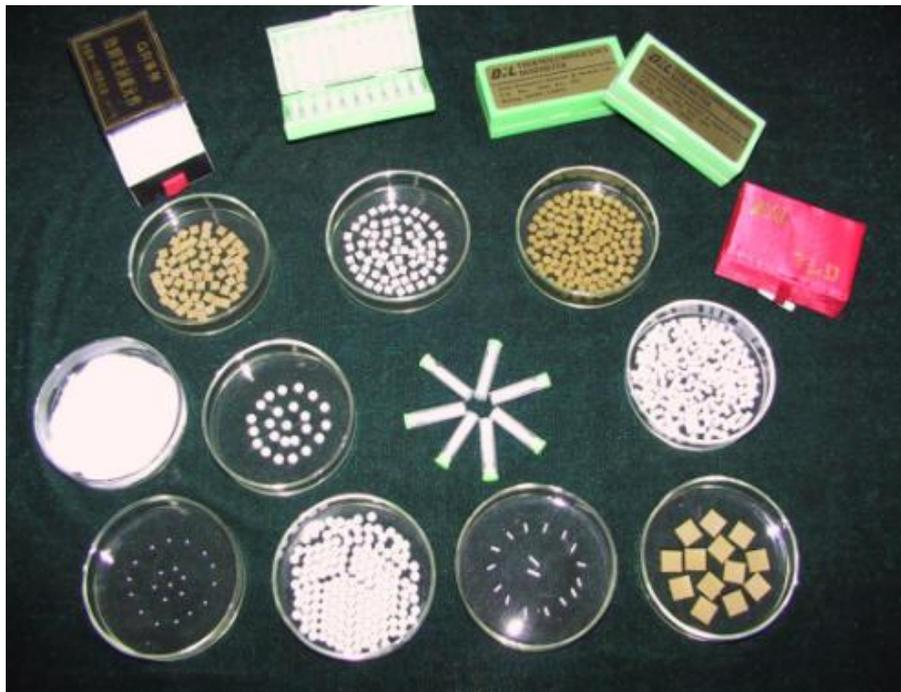
Abb 2.3: LiF:Mg,Cu,P-TLD-Produktpalette von Hersteller *Solid Dosimetric and Detector and Method Laboratory*, Peking, China
