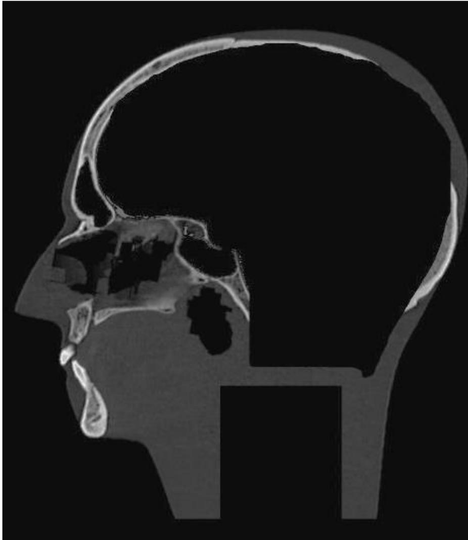
Abb. 4.9: Schnitt in Sagittalebene (erschaffener Hohlraum und zylindrische Bohrung für Halterung im Halsbereich erkennbar)
