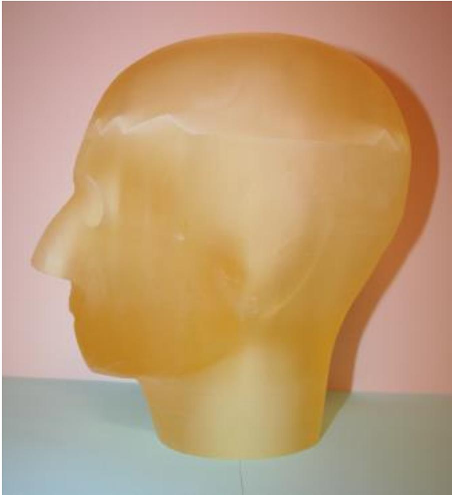
Abb. 4.30: Gereinigtes Werkstück: *Schädelphantom Teil A* und *Schädelphantom Teil B* –
