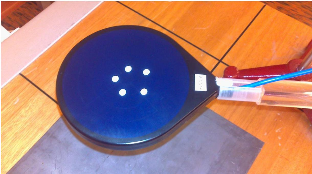
Abb. 3.15: Positionierung von 5 TLD-Chips direkt auf der strahlzugewandten Oberseite der SFD-Kammer (Typ 34060, PTW-Freiburg, Freiburg, Deutschland)
