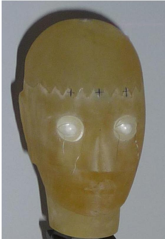
Abb. 4.34: Fertiges Schädelphantom samt Augeneinsätzen
