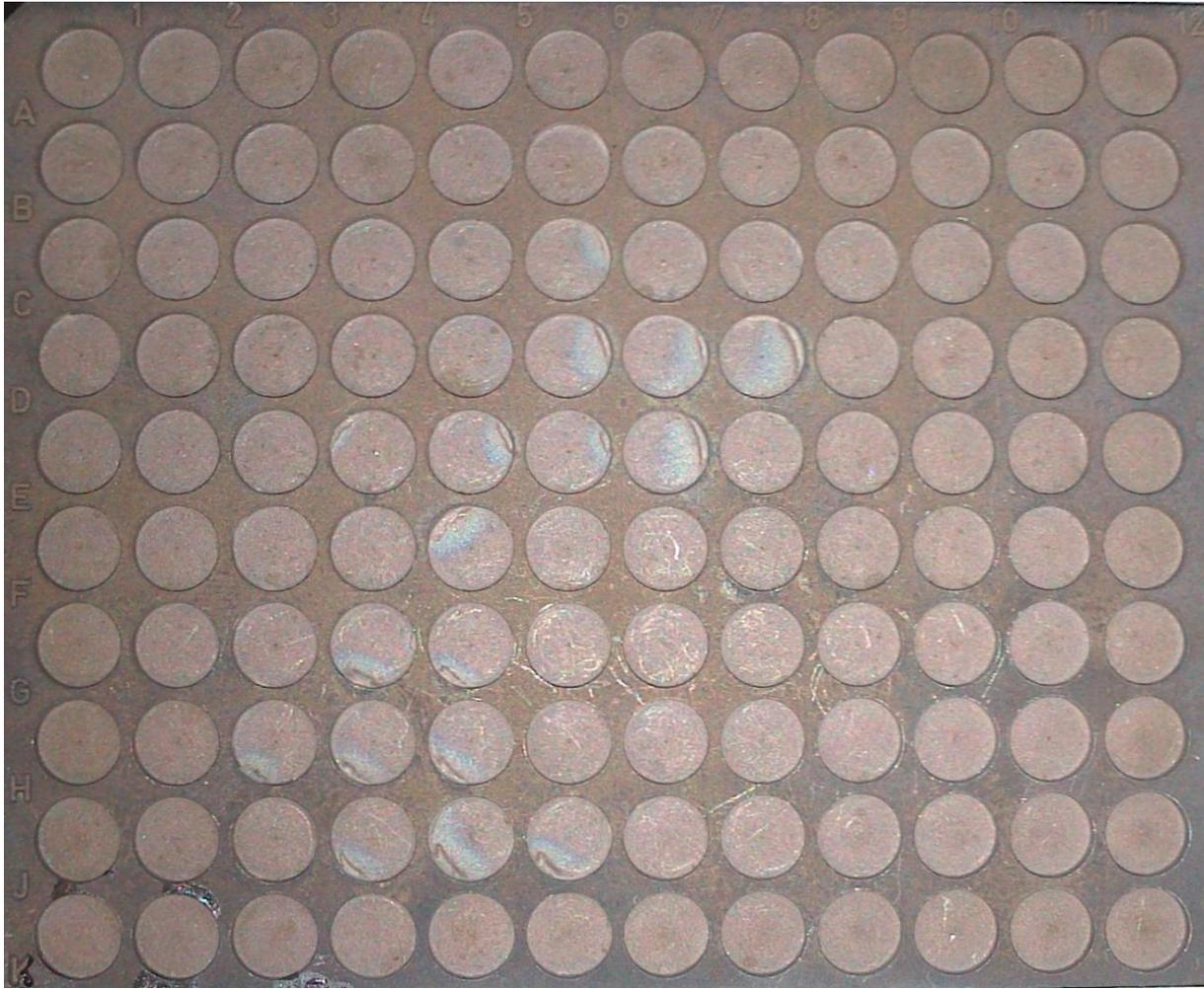
Abb. 3.1: Ausheizblech des *Atominstytut der Technischen Universität Wien*; 120 Ausfräsungen für TLD-Chips
