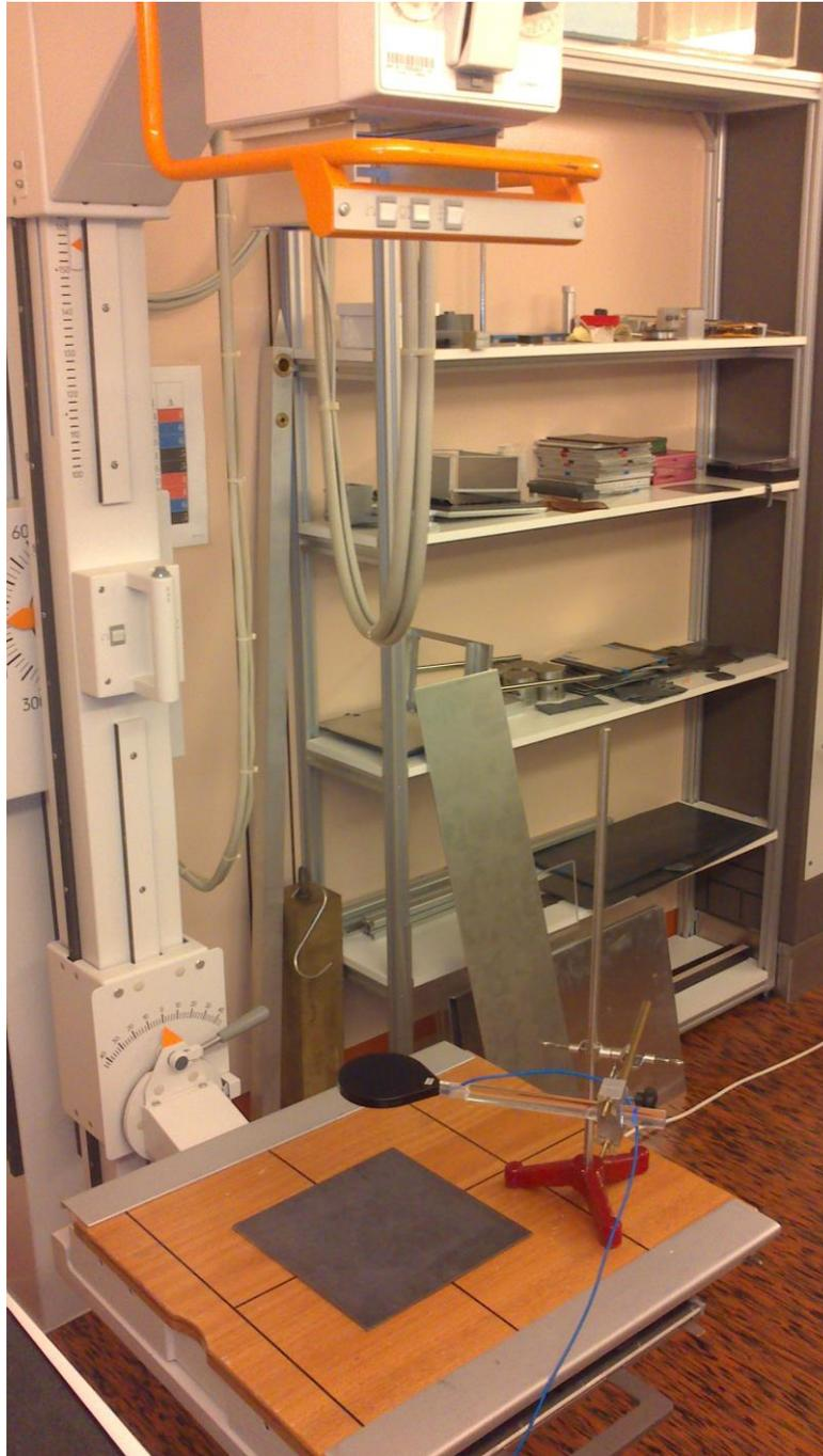
Abb. 3.14: Messaufbau zur Röntgenkalibrierung der TLD-Chips, Abstand Röntgenquelle – SFD-Kammer: 130 cm; Abstand SFD-Kammer – Beamstop: 20 cm
