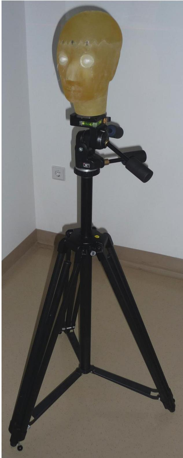
Abb. 4.38: Kompletter Messaufbau – Stativ, Stativkopf, Halterung, Schädelphantom, Augeneinsätze
