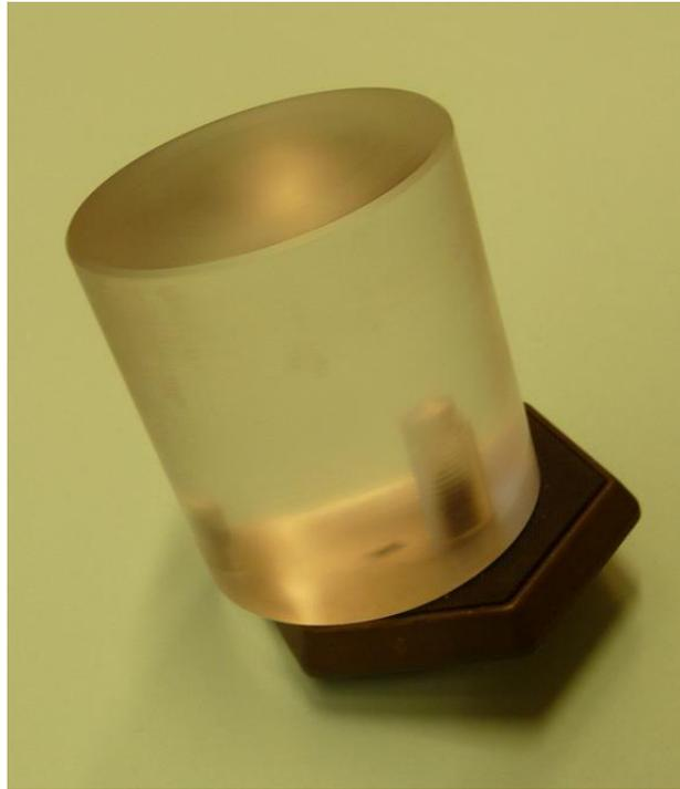
Abb. 4.37: Halterung: Schnellwechselplatte mit befestigtem PMMA-Zylinder
