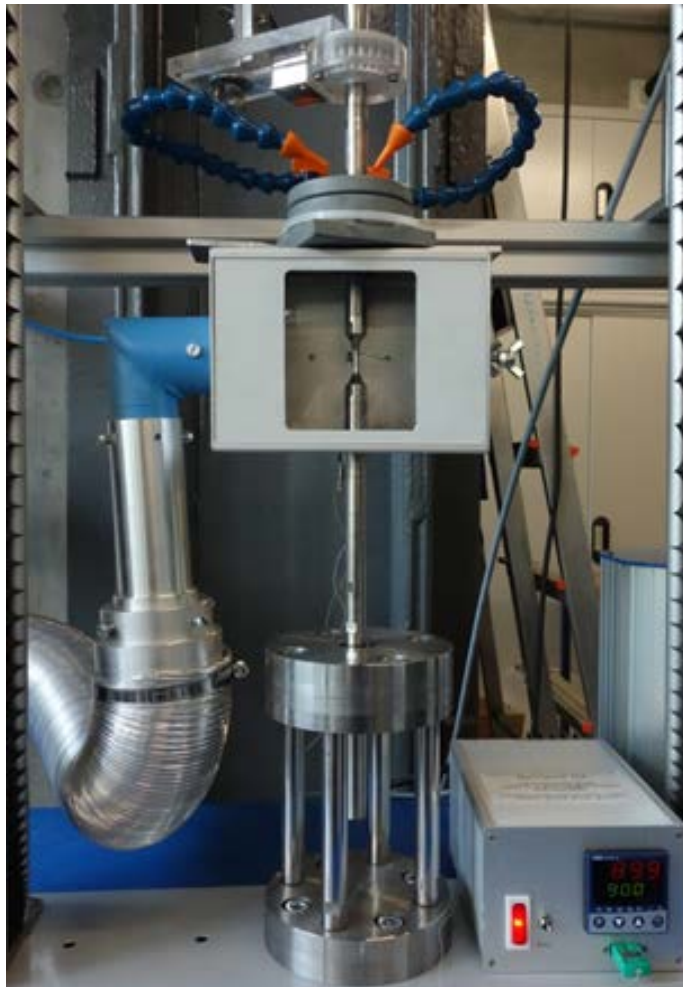
Abbildung 4.6 Prüfkammer für Versuche an Luft bei 90°C
